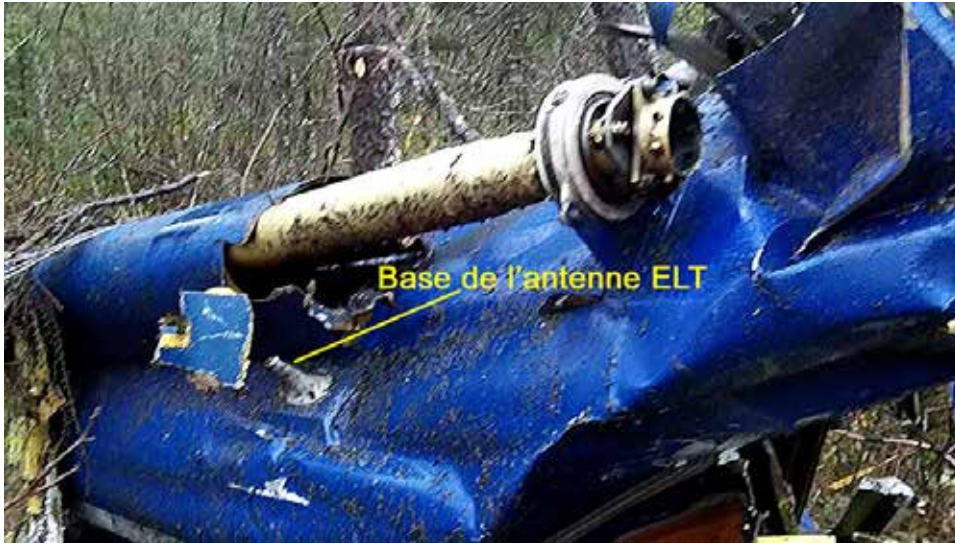
Figure 6. Saisie d'image d'une vidéo de l'épave prise sur place montrant l'antenne de la radiobalise de repérage d'urgence (ELT) rompue
