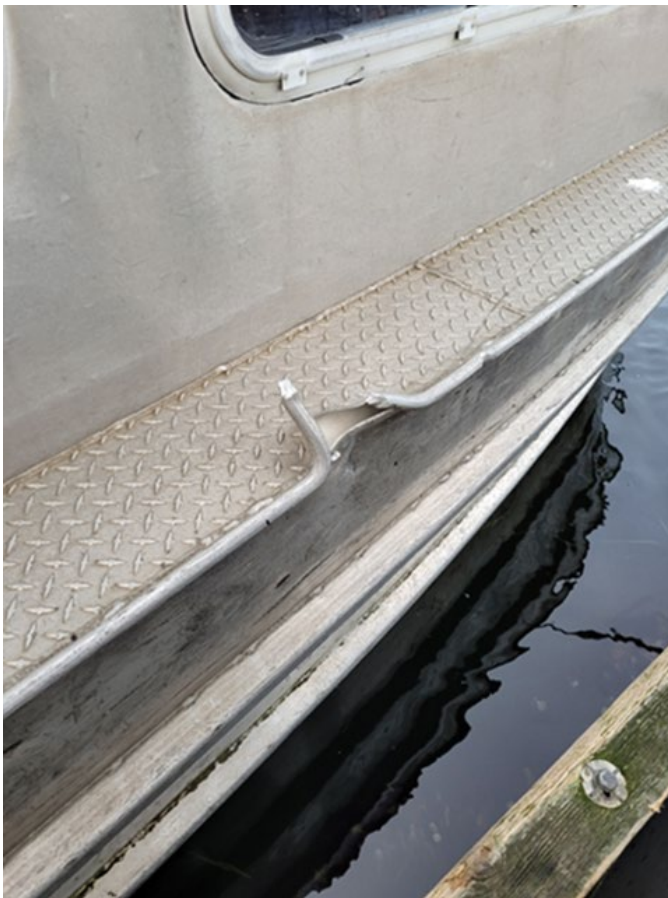
Figure 5. Dommages à la coque du côté tribord du bateau (Source : propriétaire du bateau)
