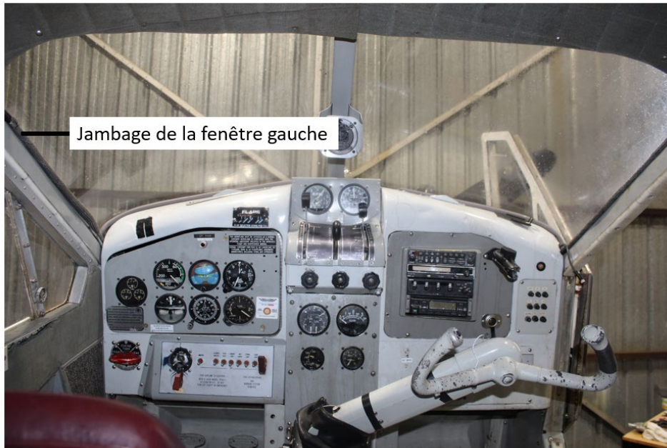
Figure 9. Poste de pilotage de l'aéronef à l'étude (Source : BST)
