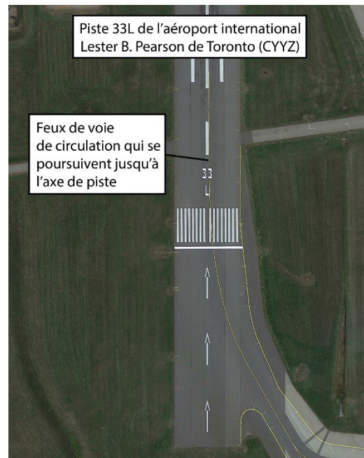
Figure 6. Balisage lumineux de voie de circulation à l'intersection de la piste 33L à l'aéroport international Lester B. Pearson de Toronto (Source : Google Earth, avec annotations du BST)
