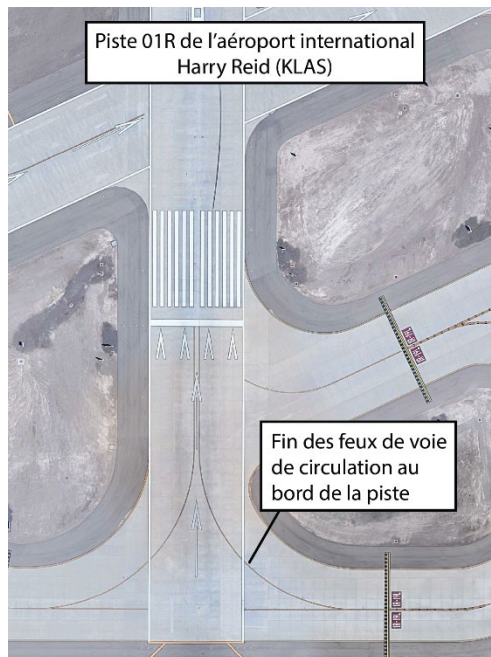
Figure 5. Balisage lumineux de voie de circulation à l'intersection de la piste 01R à l'aéroport international Harry Reid (Source : Google Earth, avec annotations du BST)
