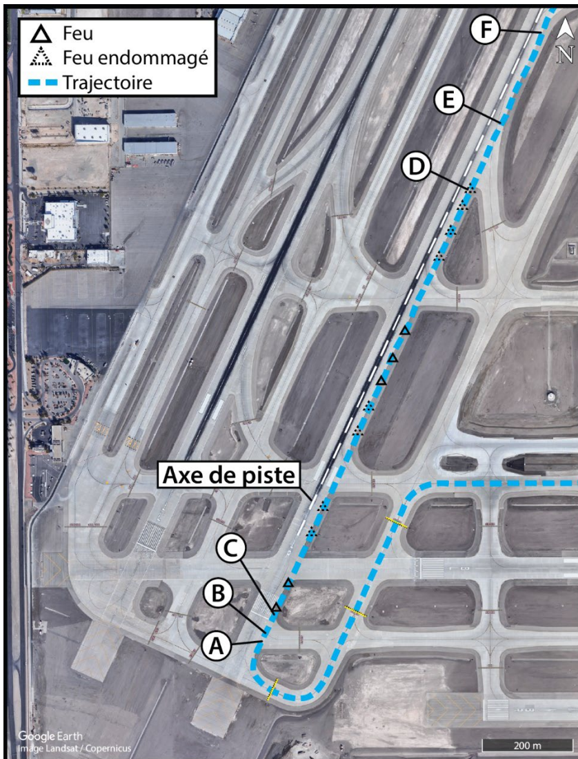
Figure 2. Trajectoire de décollage de l'aéronef à l'étude, selon les données de l'enregistreur à accès rapide et de la surveillance dépendante automatique en mode diffusion. Les positions des feux de bord de piste sont indiquées, tout comme les emplacements (A à F, énumérés dans le tableau 1) auxquels l'équipage de conduite a exécuté des actions importantes pendant la séquence du décollage (Source : Google Earth, avec annotations du BST)
