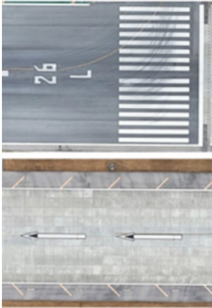
Figure 3. Seuil de piste (en haut) et zone de seuil décalé (en bas) à l'aéroport international de Vancouver (Source : Google Earth)
