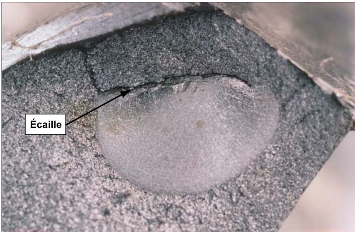
Photo 2. Gros plan d'une fissuration transversale progressive amorcée en surface
