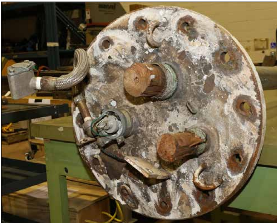
Figure 5. Raccords supérieurs; des chevilles de bois sont enfoncées dans les emplacements des robinets où les conduites de liquide et de vapeur ont été arrachées.
