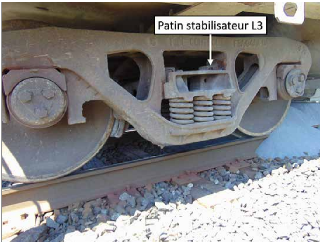
Figure 11. Bout A du wagon NAHX 35909 montrant le soulèvement du patin stabilisateur L3
