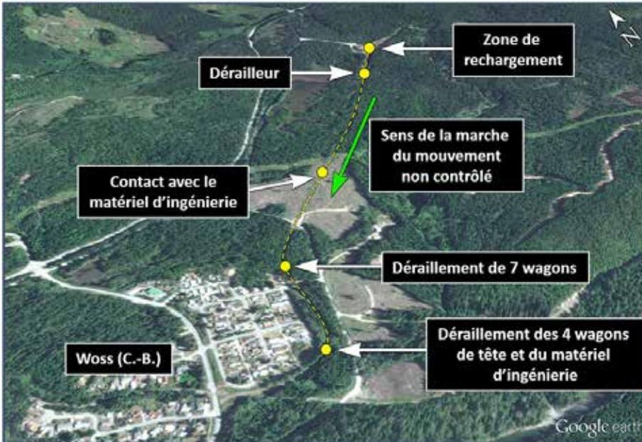
Figure 7. Positions des wagons et du matériel d'ingénierie à l'emplacement du déraillement
