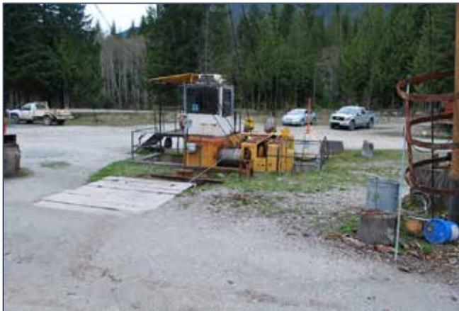
Figure 12. Bâti en A pour le déchargement de grumes sur des wagons
