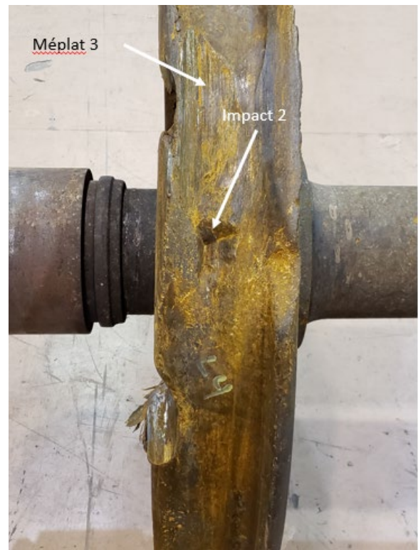
Figure 17. Table de roulement endommagée de la roue L4 montrant l'emplacement du deuxième impact et du troisième méplat (Source : BST)
