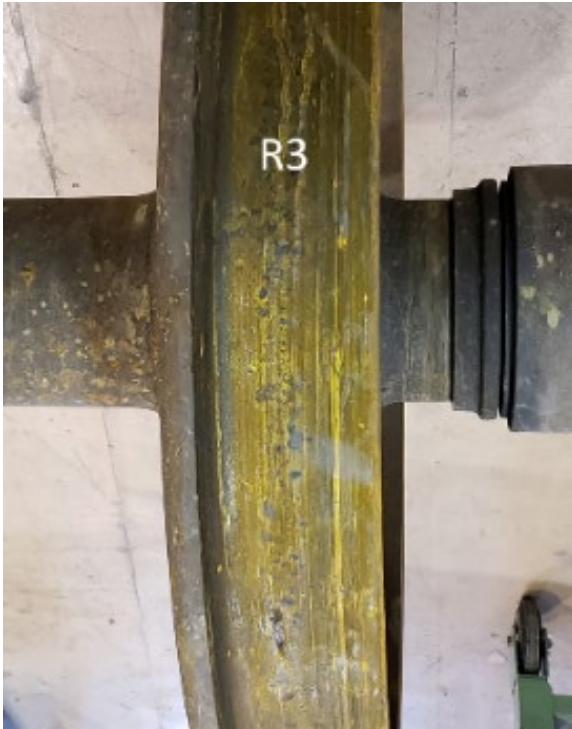
Figure 19. État de la roue R3 après le déraillement (Source : BST)
