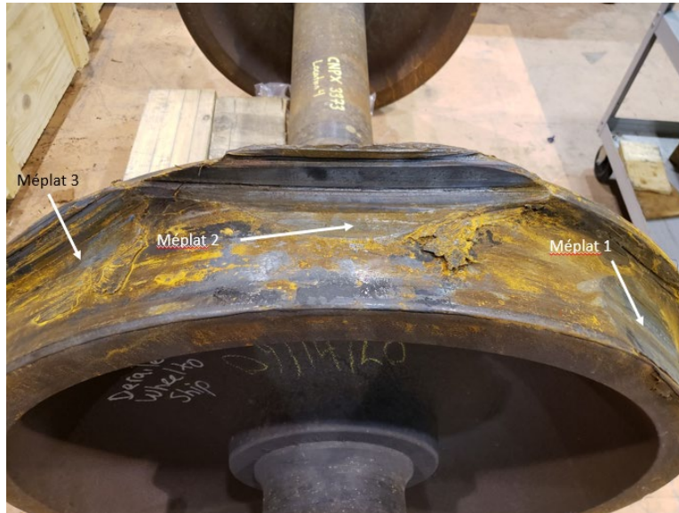
Figure 14. Table de roulement endommagée de la roue R4 montrant l'emplacement des 3 méplats (Source : BST)
