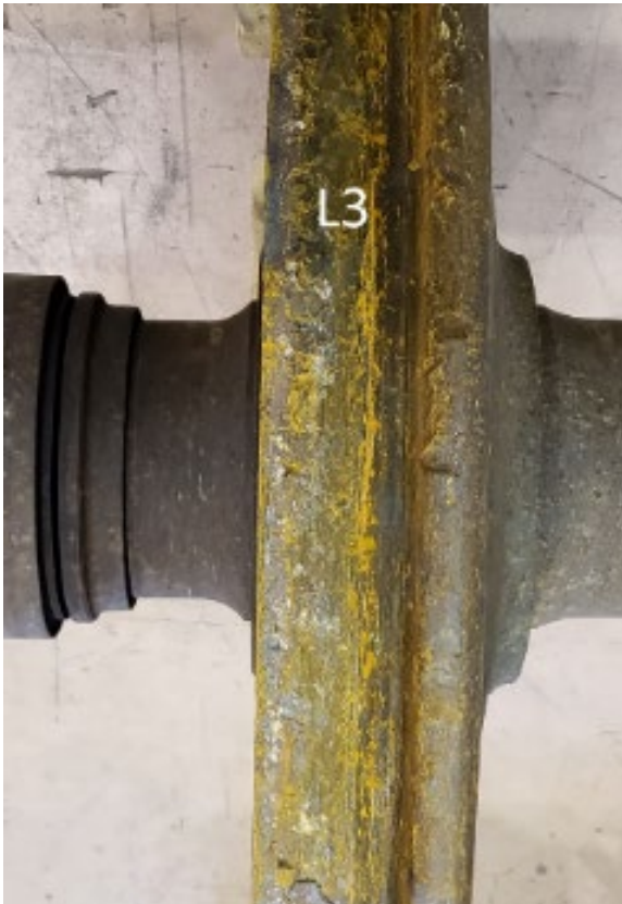
Figure 20. État de la roue L3 après le déraillement, avec une largeur de jante réduite de 1,75 pouce (Source : BST)
