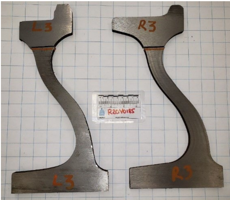
Figure 25. Échantillons radiaux de la roue L3 (à gauche) et de la roue R3 (à droite) envoyés pour une analyse par diffraction des rayons X (Source : BST)
