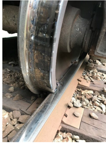
Figure 4. La roue L4 du wagon CNPX 3373 a déraillé à l'intérieur de l'écartement de la voie du rail sud (Source : Canadien National)
