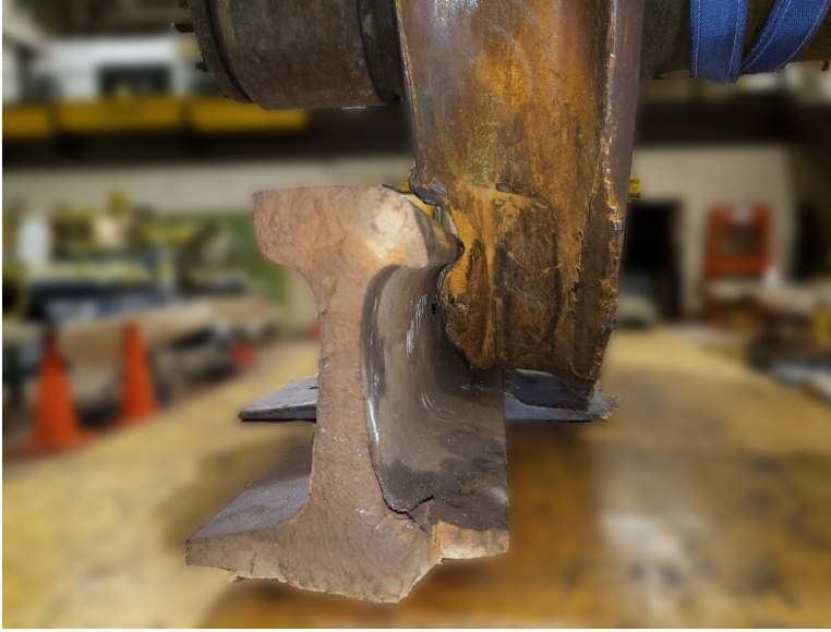
Figure 18. Deuxième sillon de la roue L4 (Source : BST)
