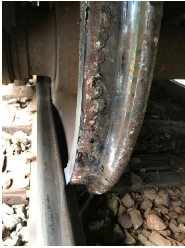
Figure 3. La roue L3 du wagon CNPX 3373 a déraillé à l'intérieur de l'écartement de la voie du rail sud (Source : Canadien National)
