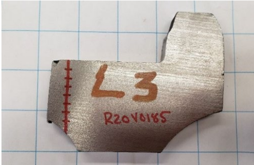
Figure 26. Emplacements des mesures de contraintes résiduelles pour la section de roue L3 (Source : BST)
