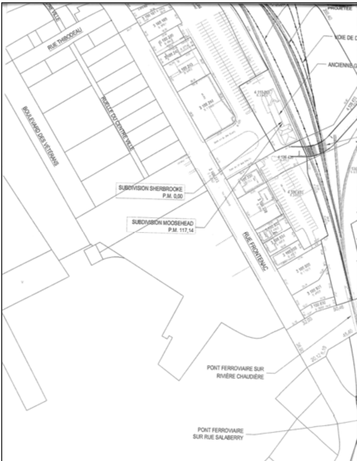
Figure 2 : Point de raccordement aux points milliaires 117,14 de la subdivision de Moosehead et 0,0 de la subdivision de Sherbrooke
