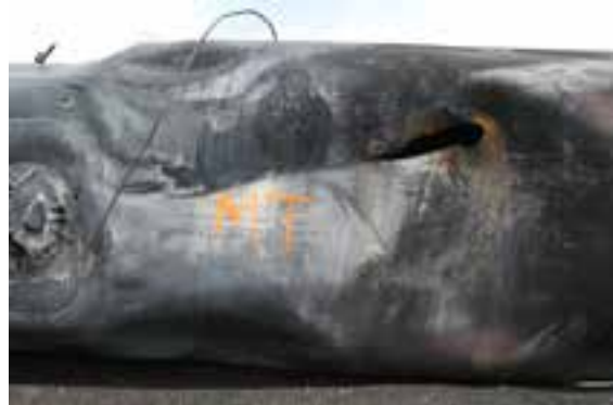
(d) Perforation de la coque
