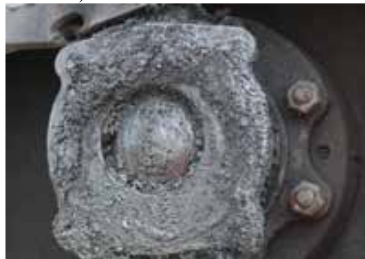
(f) Photo, prise après l'essuyage des résidus de produit, montrant la soupape à bille fermée du RDB
