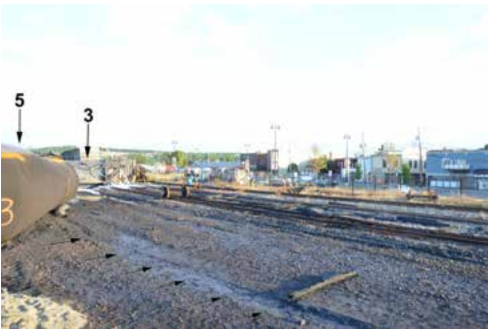
(c) Photo in situ qui montre une marque sur le sol provenant des raccords supérieurs du wagon n° 5 dlc (photo du Projet de sécurité (RSI-AAR))
