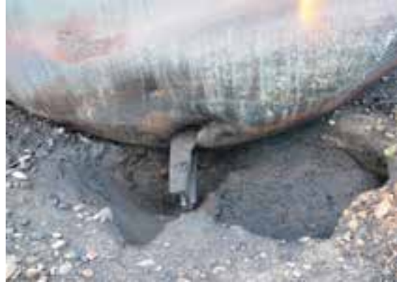
(d) Morceau de rail enfoncé photographié avant la mise en transition du wagon (photo du Projet de sécurité RSI-AAR)
