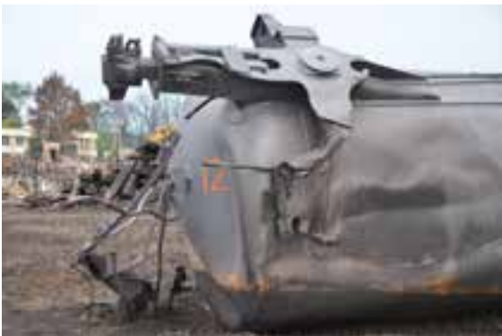
(e) Bosselure et traverse pivot endommagée sur le côté AR de la coque (photo du Projet de sécurité ferroviaire RSI-AAR)
