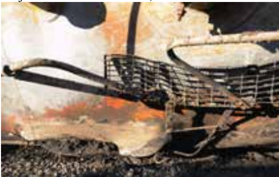
(e) Rupture thermique dans la coque – voir la flèche en (d)
