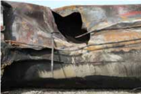
(e) Gros plan d'une grande perforation dans la coque
