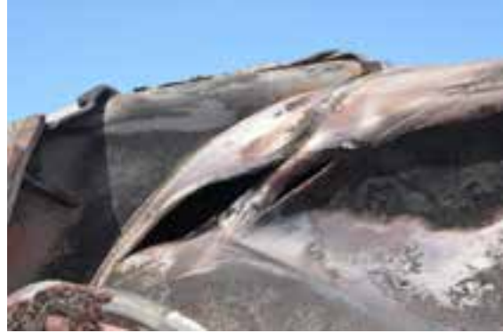
(d) Gros plan des séparations à la soudure de la plaque de renfort de la traverse pivot et à la soudure joignant la tête à la coque – voir la flèche du haut en (b) (photo du Projet de sécurité RSI-AAR)
