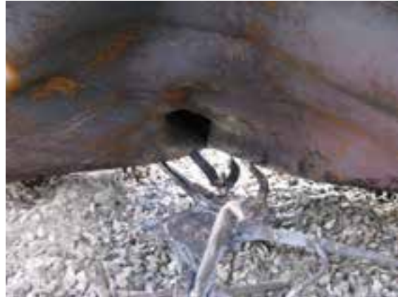
(c) Gros plan de la perforation de la coque dans la zone indiquée par la flèche en (b)
