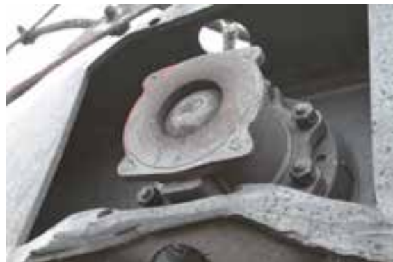
(h) Gros plan de la soupape à bille du RDB
