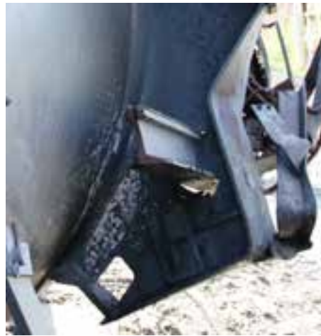
(b) Morceau de rail logé dans la traverse pivot
