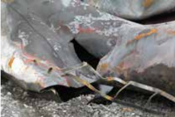
(c) Ruptures au milieu du côté droit de la coque
