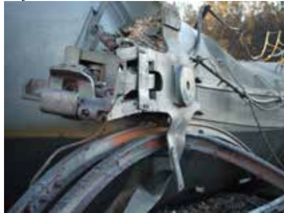
(f) Gros plan des 2 rails logés dans la traverse pivot AR (photo de Transports Canada)
