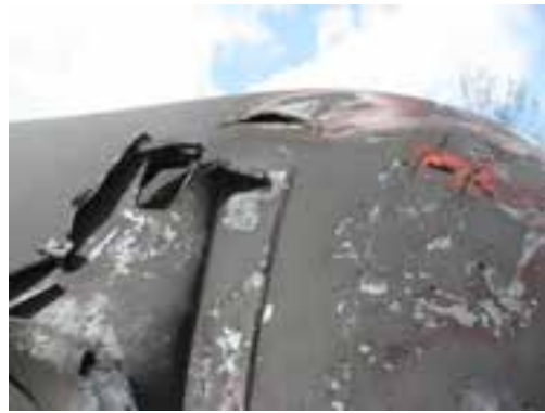
(b) Gros plan de petites ruptures au bout B
