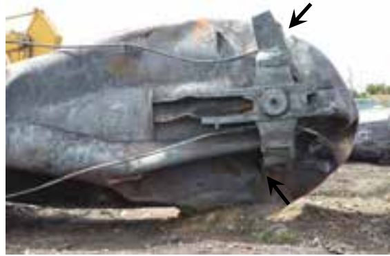
(d) Ruptures aux extrémités AL et AR de la traverse pivot au bout A (photo du Projet de sécurité RSI-AAR)
