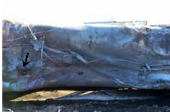
(f) Trous de brûlure et perforation (flèche) sur la coque (photo du Projet de sécurité RSI-AAR)
