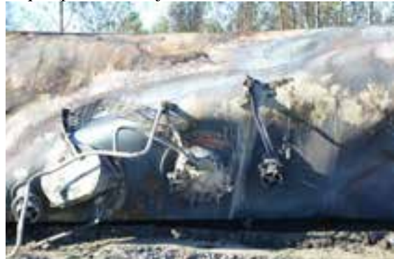
(h) Raccords supérieurs, trou d'homme et DDP (photo du Projet de sécurité RSI-AAR)
