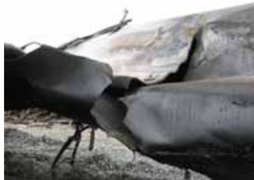
(h) Rupture dans la coque entre le RDB et le bout B
