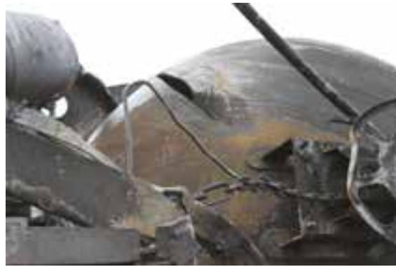
(b) Gros plan d'une perforation dans la tête du bout B
