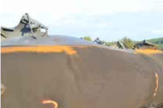
(e) Vue de la coque bombée prise avant la mise en transition du wagon (photo du Projet de sécurité RSI-AAR)
