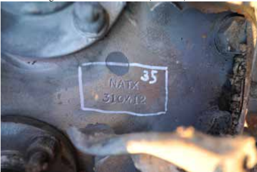
(b) Marque estampée sur la plaque-couvercle des raccords supérieurs du wagon n° 35 sur le terrain et l'identifiant comme le wagon-citerne NATX 310412 (n° 33 dlc)
