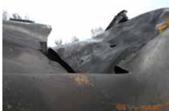
(d) Perforation et rupture de la coque
