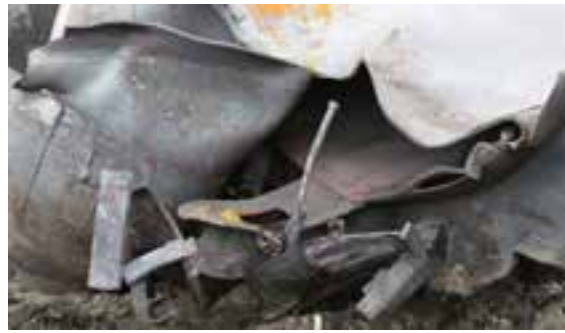
(b) Gros plan des séparations à la longrine tronquée au bout B et à la traverse pivot BR
