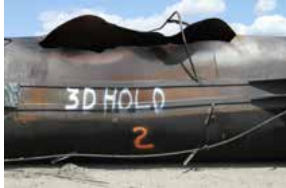
(d) Gros plan de la rupture thermique dans la coque
