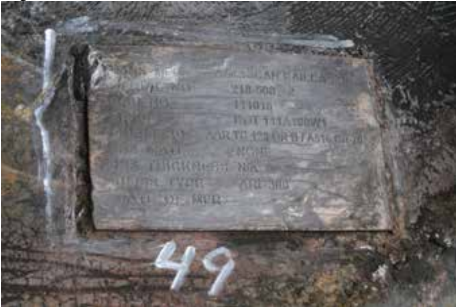
(b) Plaque d'identification de citerne soudée sur la traverse pivot du wagon CTCX 735617
