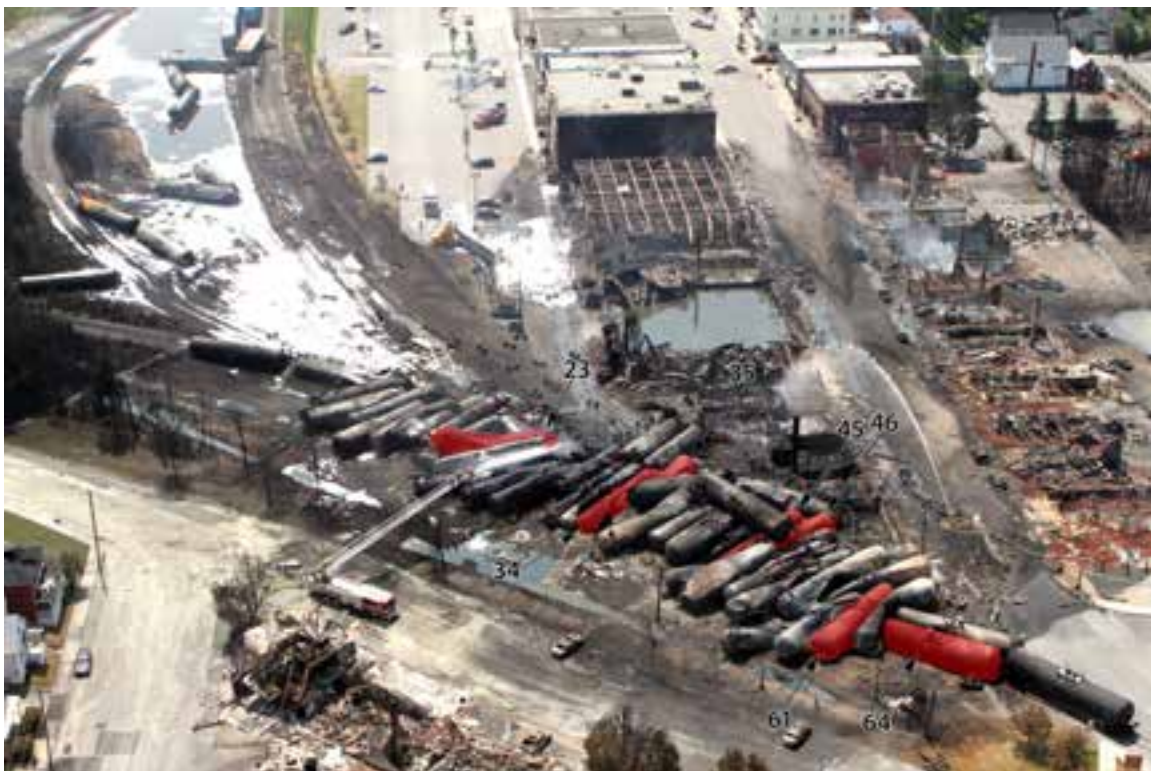
Figure 9: Photographie aérienne de wagons (en rouge) avec brèches aux RDB résultant de dommages attribuables aux chocs
