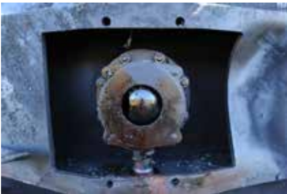
(g) Gros plan de la soupape à bille partiellement ouverte du RDB
