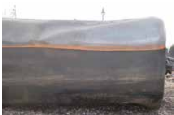
(h) Flambage dans la coque près du bout A (photo du Projet de sécurité RSI-AAR)
