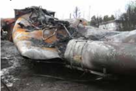
(e) Ruptures au milieu du côté gauche de la coque
