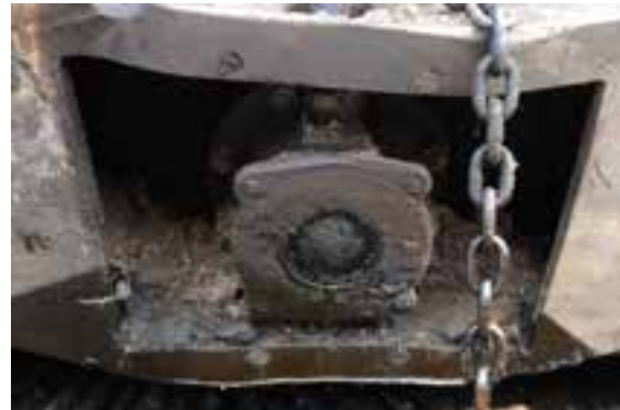
(h) Gros plan de produit fuyant par le RDB
