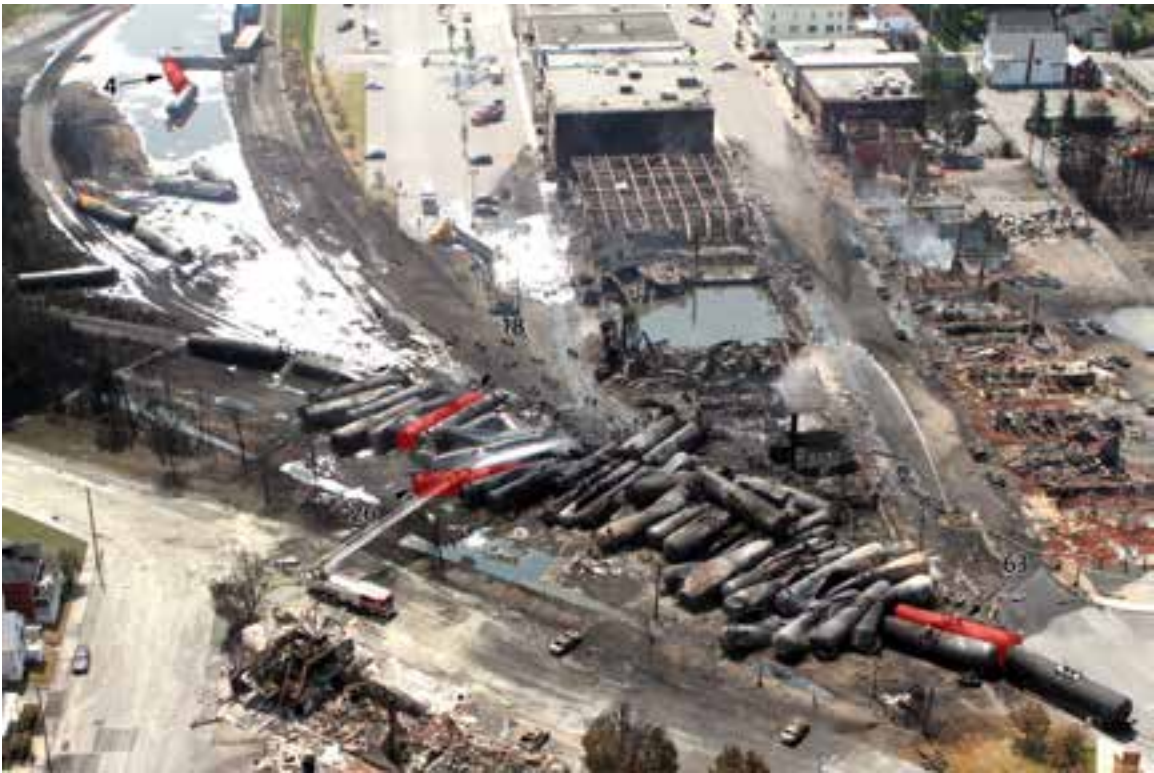
Figure 10: Photographie aérienne de wagons (en rouge) avec brèches résultant de ruptures thermiques
