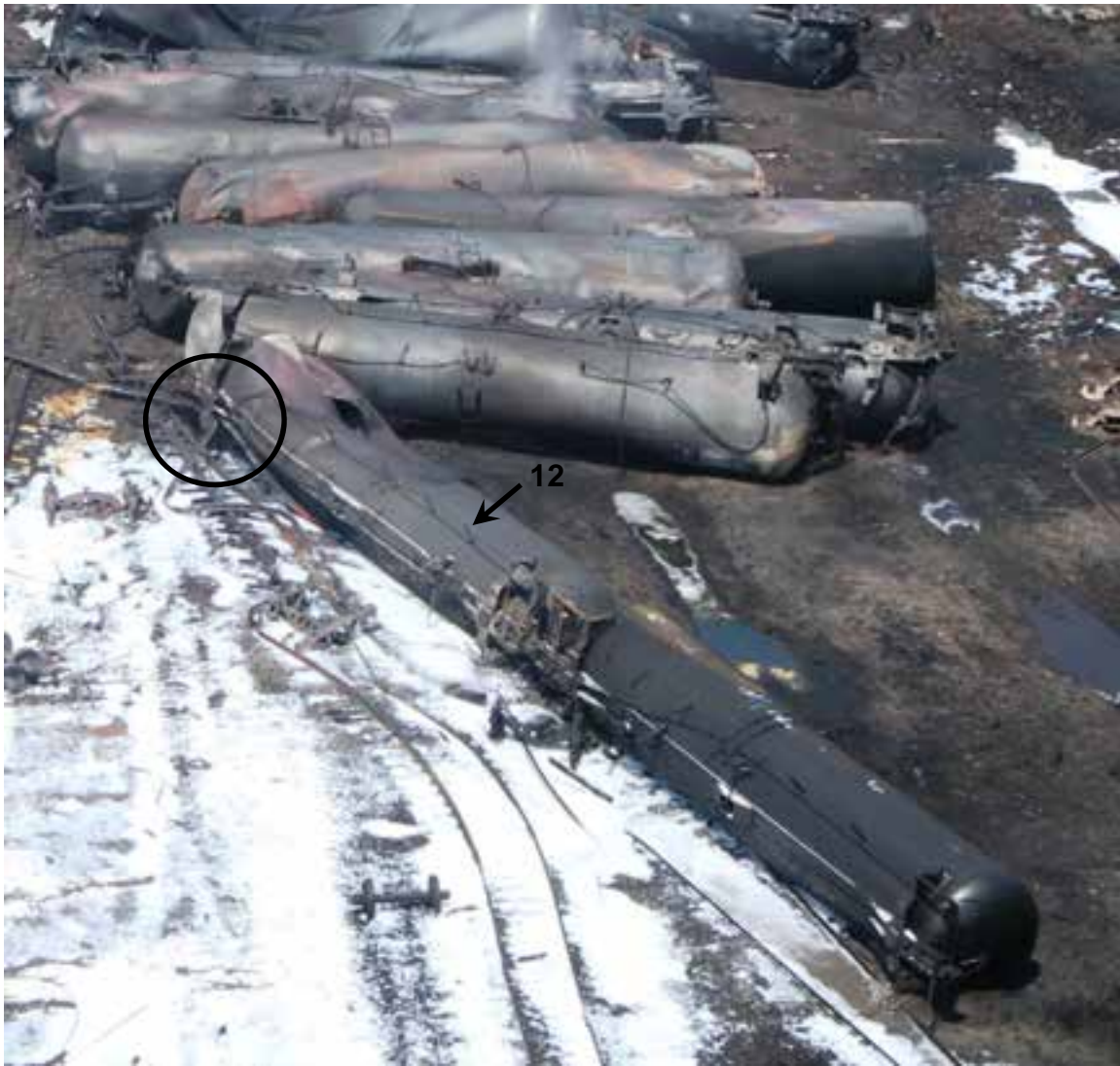
(c) Vue vers l'ouest. Remarquer les rails empalés dans la traverse pivot du wagon (cercle).
