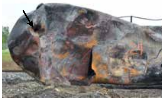
(f) Détail d'une grande rupture de coque et d'une perforation plus petite (flèche) (photo du Projet de sécurité RSI-AAR)
