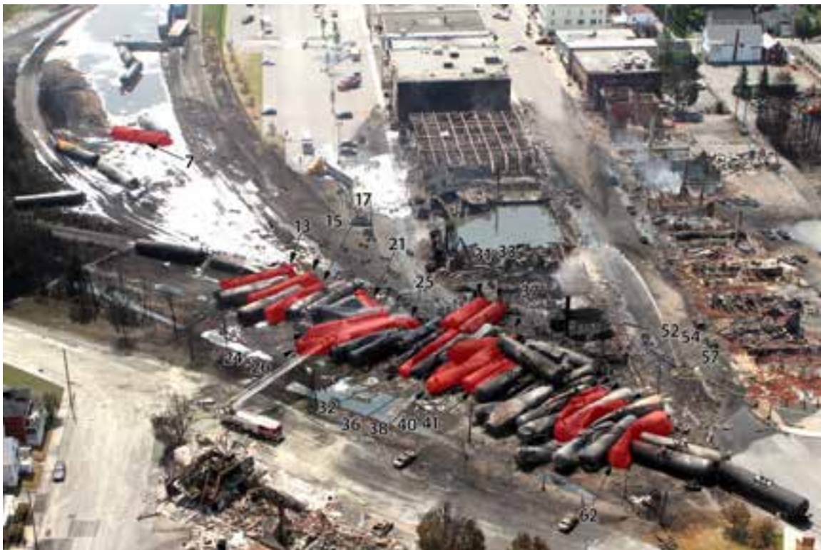
Figure 7: Photographie aérienne de wagons (en rouge) avec brèches aux raccords supérieurs résultant de dommages attribuables aux chocs
