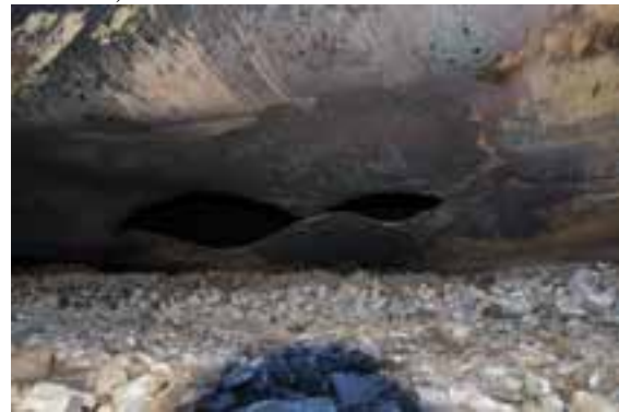
(d) Gros plan de la rupture dans le haut de la coque – voir la flèche en (c) (photo du Projet de sécurité RSI-AAR)
