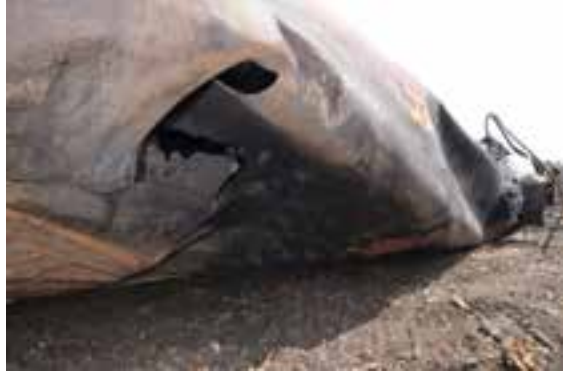
(d) Détail d'une rupture de coque (photo du Projet de sécurité RSI-AAR)
