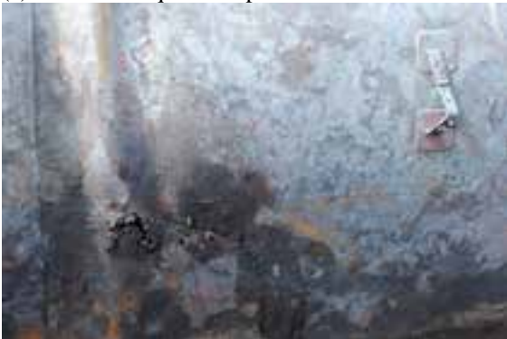
(e) Trou de brûlure sur le côté gauche de la coque - voir la flèche en (d)
