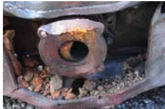
(h) Gros plan de la soupape à bille partiellement ouverte du RDB
