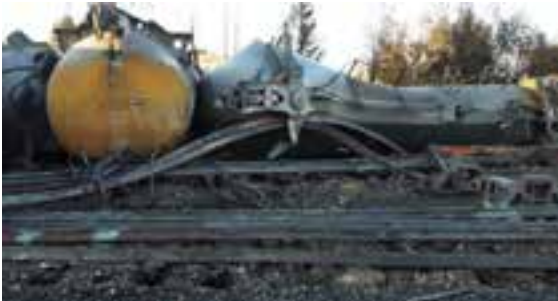
(e) Photo in situ des rails logés dans la traverse pivot AR du wagon (photo de Transports Canada)
