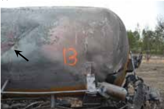
(e) Bosselure et petite perforation (flèche) sur le côté BL de la citerne (photo du Projet de sécurité ferroviaire RSI-AAR)
