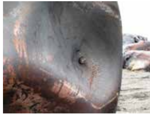
(b) Gros plan d'une petite perforation dans la tête du bout B - voir la flèche en (a)
