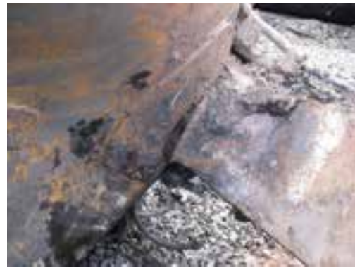
(b) Gros plan de la séparation à la soudure d'angle joignant la cale de bout de citerne au bout B à la plaque de renfort avant - voir la flèche en (a)
