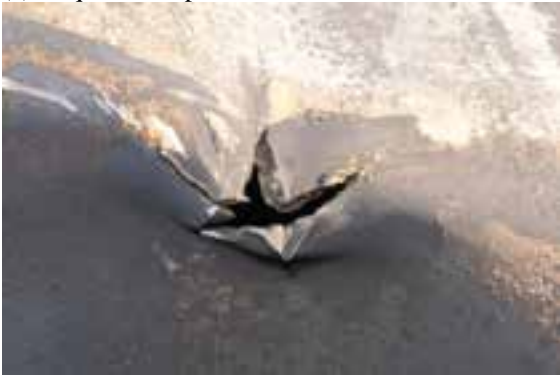
(c) Gros plan d'une petite perforation dans la partie encerclée de la tête du bout A – voir (b) (photo du Projet de sécurité RSI-AAR)
