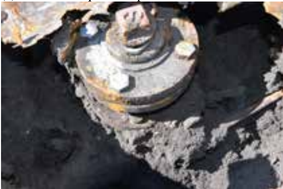
(e) Gros plan de résidus de produit dans l'enceinte (photo du Projet de sécurité RSI-AAR)
