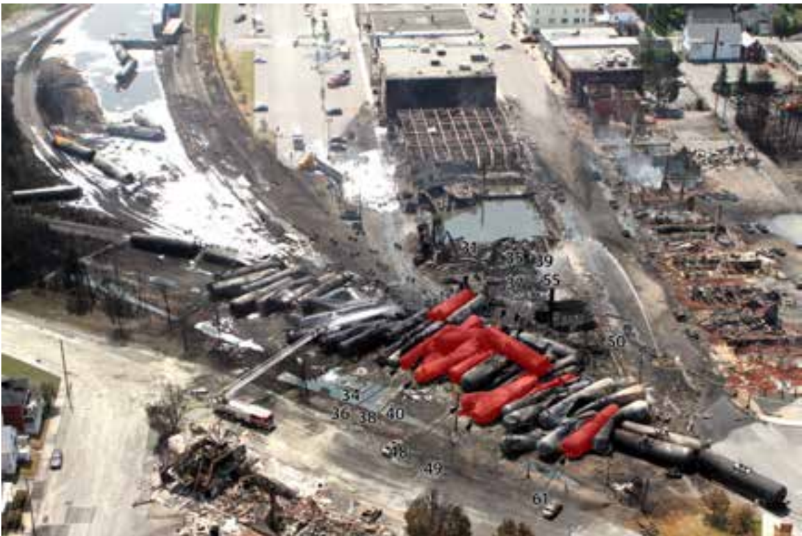
Figure 11: Photographie aérienne de wagons (en rouge) avec trous de brûlure
