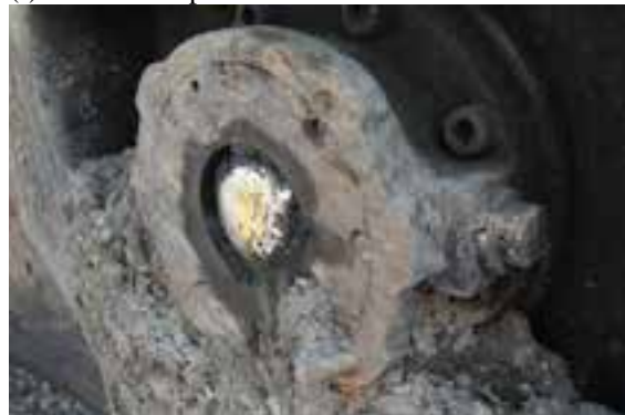
(h) Gros plan d'un léger suintement par le RDB
