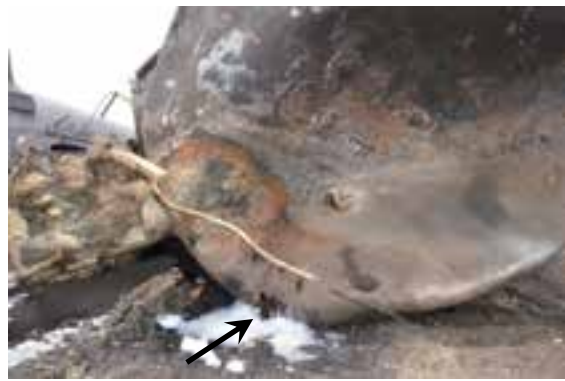
(b) Gros plan d'une petite perforation au bord de la tête au bout B (photo du Projet de sécurité RSI-AAR)
