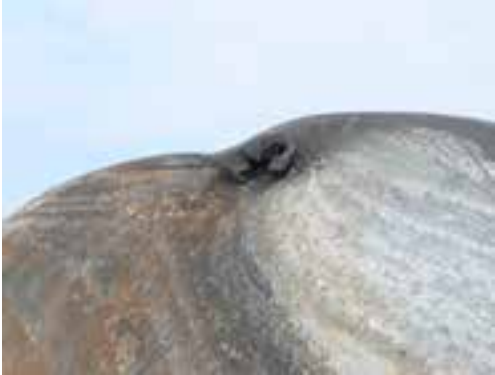
(c) Gros plan d'une rainure et d'une perforation sur la tête du bout A (photo du Projet de sécurité RSI-AAR)
