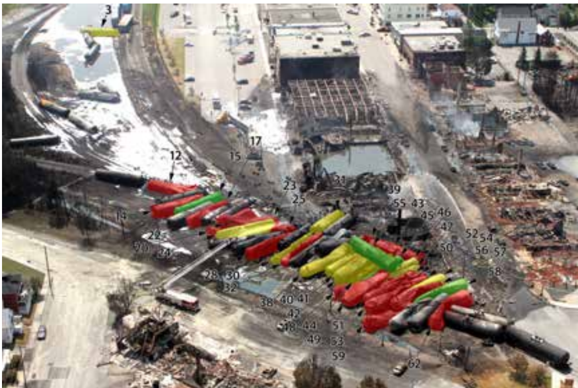
Figure 5: Photographie aérienne de wagons avec des petites (en vert), moyennes (en jaune) ou grandes (en rouge) brèches de coque
