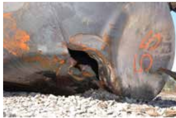
(b) Gros plan de la perforation au bord de la tête du bout B - voir la flèche en (a) (photo du Projet de sécurité RSI-AAR)
