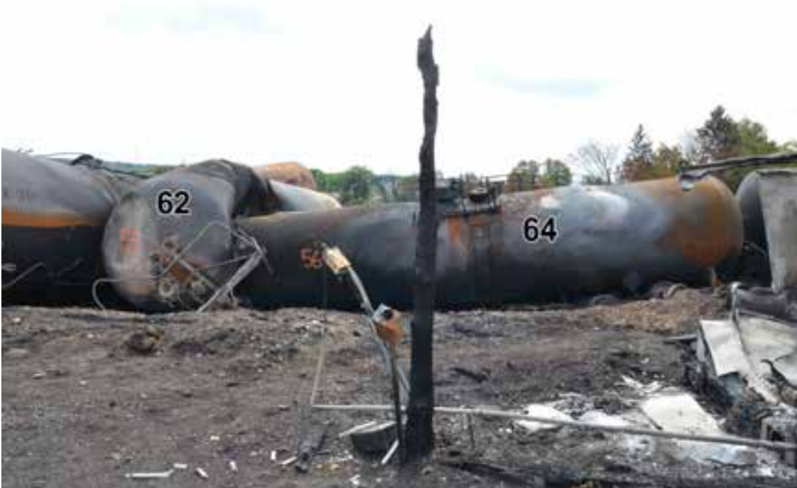
Figure B-8: Photo in situ montrant la tête du wagon n o 64 dlc (n o 56 sur le terrain) percutée contre le wagon n o 62 dlc (n o 55 sur le terrain) (photo du Projet de sécurité RSI-AAR)
