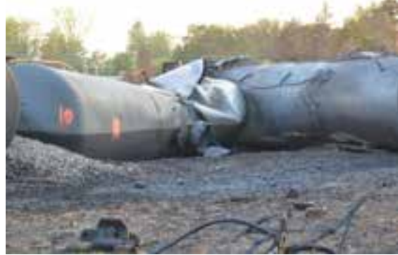
(d) Photo in situ montrant le flambage de la coque au bout A et le ballast empilé au bout B (photo du Projet de sécurité RSI-AAR)
