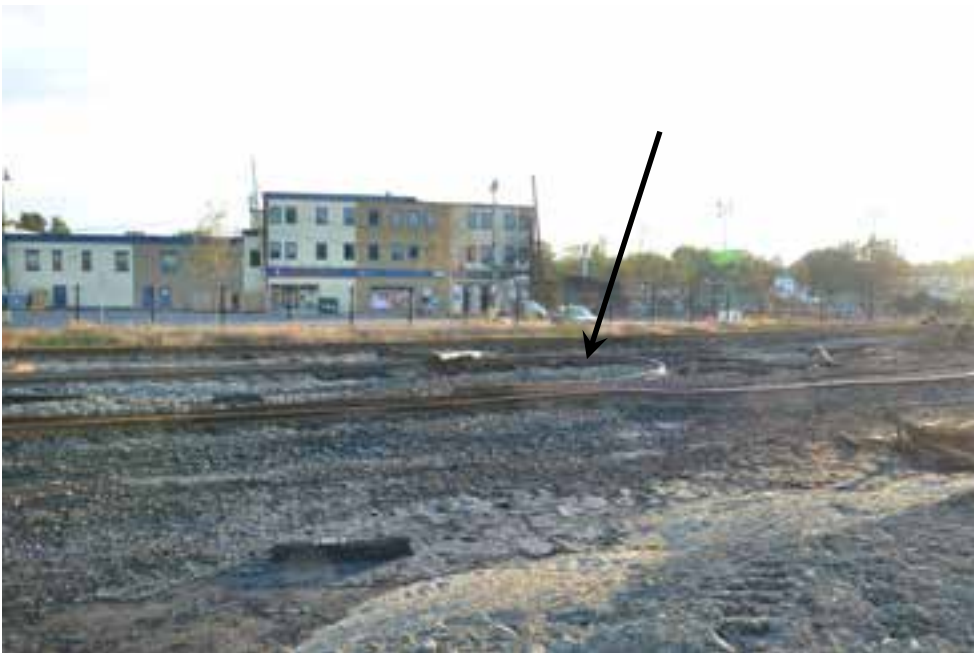
(d) Photo in situ montrant un gros plan de la zone encerclée dans la figure B-3a La flèche indique un rail brisé courbé vers l'arrière à 180 degrés (photo du Projet de sécurité RSI-AAR)
