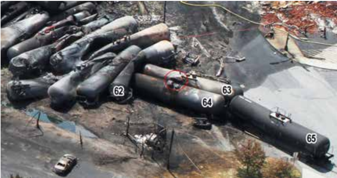
(b) Vue vers le sud-ouest. La rupture thermique dans le wagon NATX 310515 (n° 63 dlc) est encerclée.
