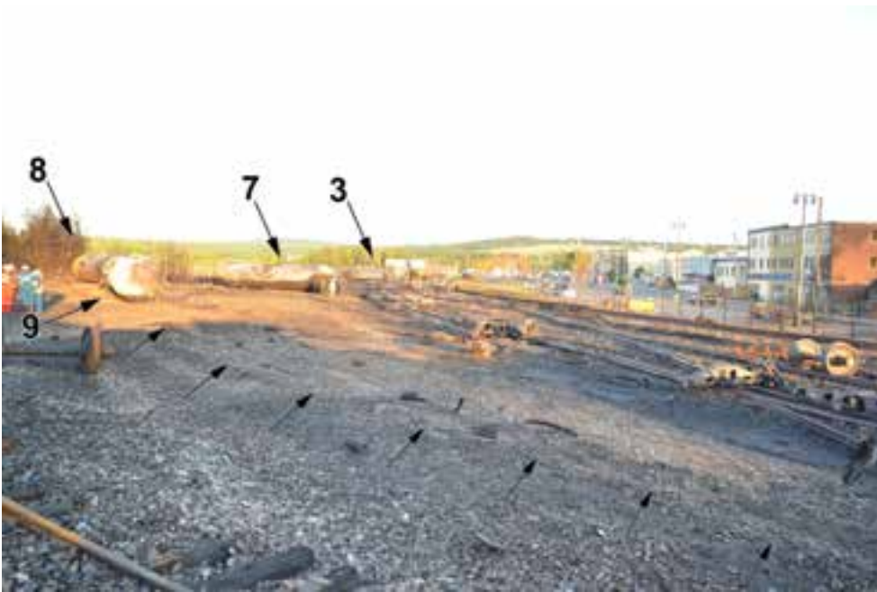
(e) Photo in situ qui montre une marque sur le sol et des débris provenant des wagons n os 8 et 9 dlc (photo du Projet de sécurité RSI-AAR)
