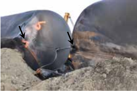
(c) Photo montrant l'alignement des perforations de tête sur les wagons CTCX 735541 (à gauche) et DBUX 303879 (à droite) (photo du Projet de sécurité RSI-AAR)
