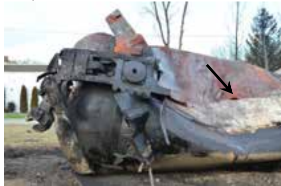
(d) Gros plan d'une petite rupture dans le bas de la coque (flèche) (photo du Projet de sécurité RSI-AAR)
