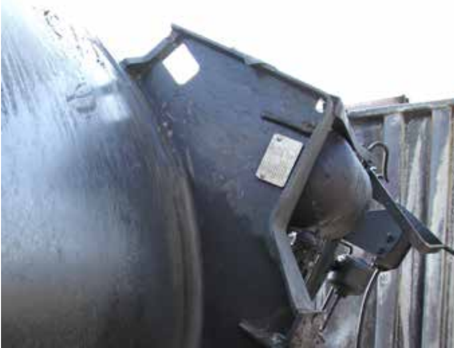
(a) Plaque d'identification de citerne sur le côté intérieur de la traverse pivot BL du wagon WFIX 30682
