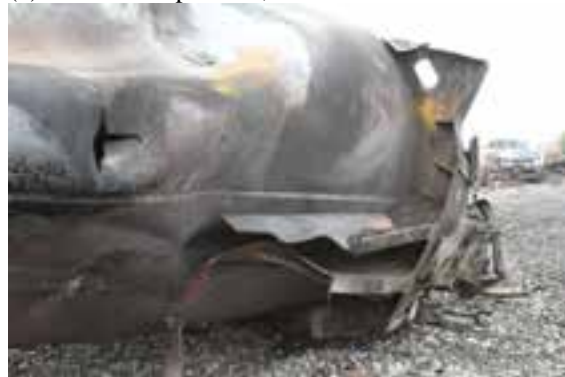
(f) Gros plan d'une petite perforation dans la coque
