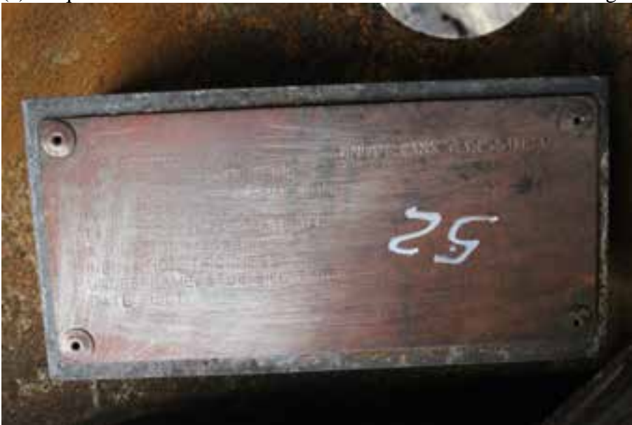
(d) Plaque d'identification de citerne avec texte manquant observée sur le wagon PROX 44428
