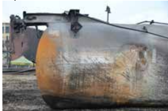
(d) Gros plan d'une bosselure sur le côté AR de la citerne (photo du Projet de sécurité RSI-AAR)
