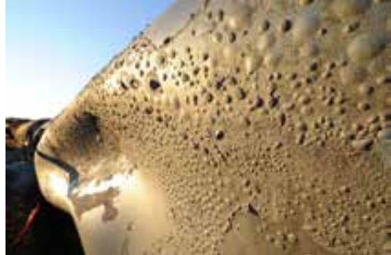
(d) Gros plan de cloques et de perte de métal sur la coque
