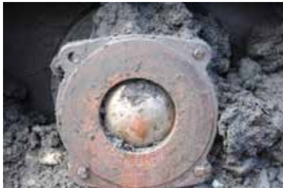
(f) Gros plan de la soupape à bille partiellement ouverte du RDB
