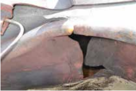
(c) Gros plan d'une rupture dans la zone encadrée en (a) (photo du Projet de sécurité RSI-AAR)
