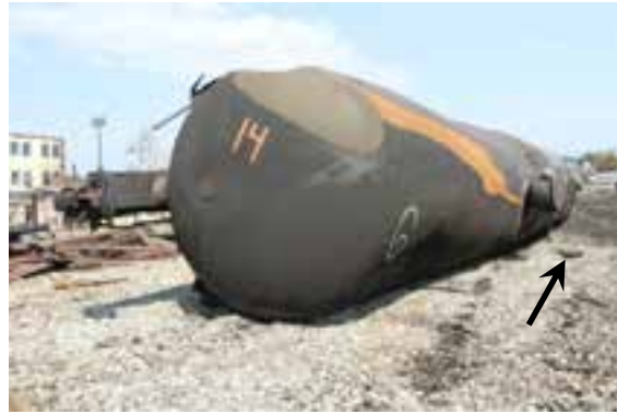
(b) Tête du bout A. La flèche pointe vers le couvercle de trou d'homme détaché.
