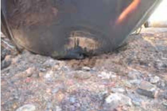
(c) Photo in situ d'une petite perforation au bord gauche du bout A (photo du Projet de sécurité RSI-AAR)
