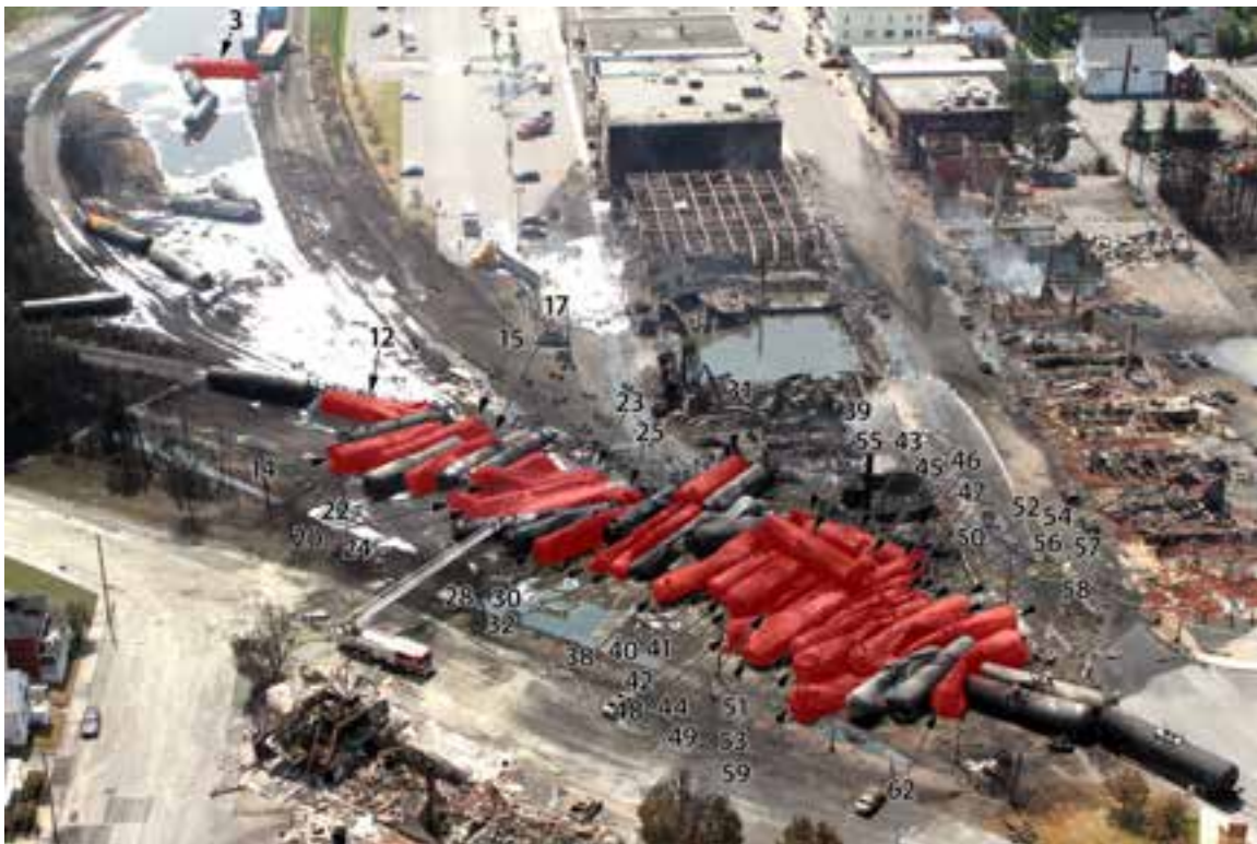
Figure 4: Photographie aérienne de wagons (en rouge) avec brèches de coque résultant de dommages attribuables aux chocs
