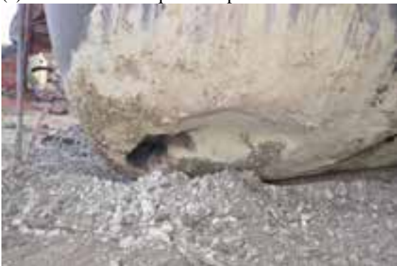
(g) Gros plan du côté perforé de la coque au bout A (photo du Projet de sécurité RSI-AAR)
