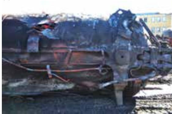
(d) Trou de brûlure dans la coque (photo du Projet de sécurité RSI-AAR)
