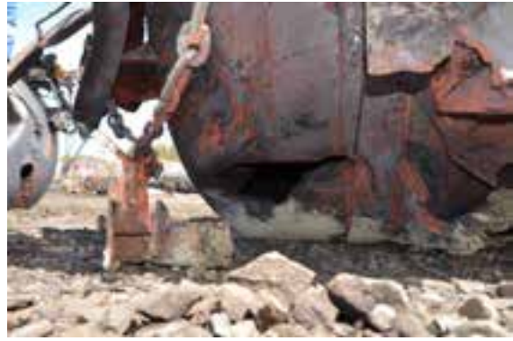
(b) Gros plan de la perforation indiquée par la flèche en (a) (photo du Projet de sécurité RSI-AAR)
