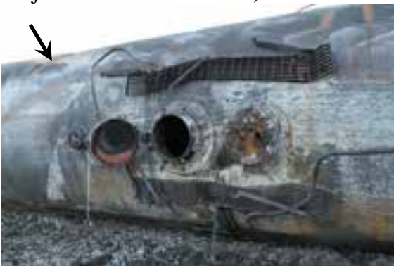
(e) Raccords supérieurs et trou d'homme. La flèche pointe vers une bosselure en angle dans la coque.
