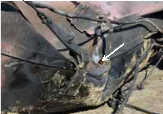
(e) Gros plan d'une petite rupture (flèche) dans la zone encadrée en (c) (photo du Projet de sécurité RSI-AAR)
