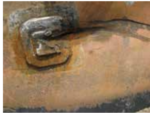
(b) Gros plan d'une petite perforation dans la tête du bout B
