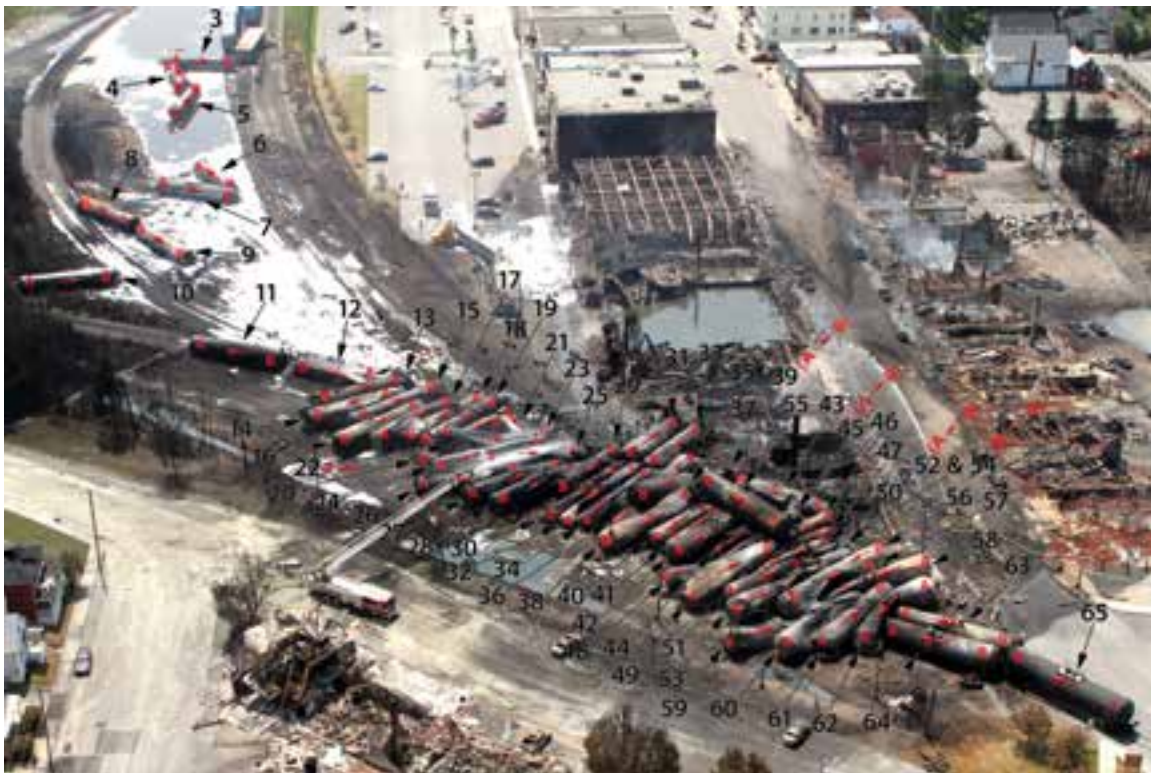
(a) Les bouts A et B sont marqués sur chaque wagon-citerne déraillé. Les flèches indiquent l'extrémité avant du wagon dans le train en cause.
