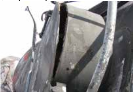
(e) Résidus de produit dans le jeu entre l'enceinte et le couvercle
