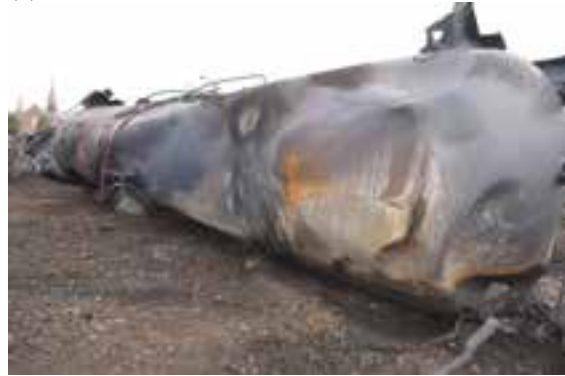
(d) Vue du flambage longitudinal sur toute la longueur de la citerne (photo du Projet RSI-AAR de sécurité ferroviaire)
