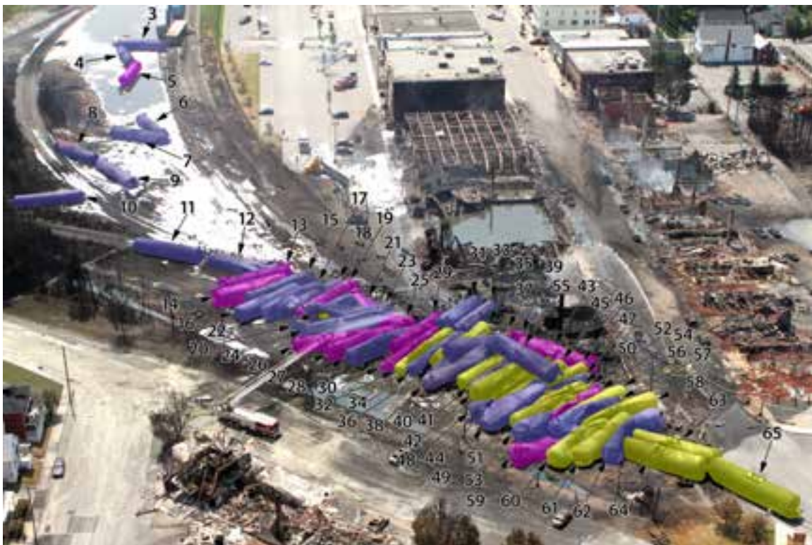
(b) Le code de couleurs indique dans quelle position chaque wagon s'est immobilisé : jaune (debout), rose (sens dessus dessous) et violet (sur son côté).
