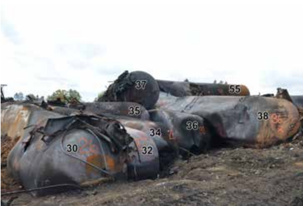
(a) Vue montrant les wagons-citernes déraillés partiellement encastrés dans le sol et écrasés les uns contre les autres. Sont visibles les extrémités des wagons n os 30, 32, 34, 36 et 38 dlc (respectivement les wagons n os 26, 27, 28, 31 et 36 sur le terrain) (photo du Projet de sécurité RSI-AAR).
