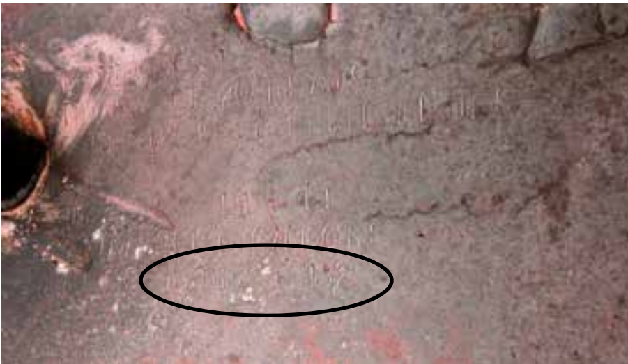
(c) Marque estampée « R50175-182 » (encerclée) sur la tête du wagon n° 21 sur le terrain et l'identifiant comme le wagon-citerne NATX 310581 (n° 27 dlc)
