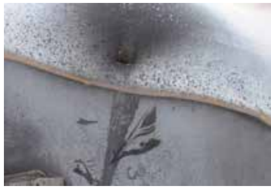
(b) Gros plan d'une petite perforation dans la tête du bout B
