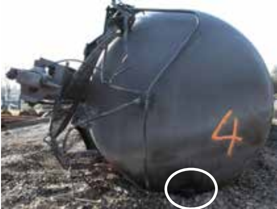
(c) Tête du bout A où s'est logé un morceau de rail (encerclé)
