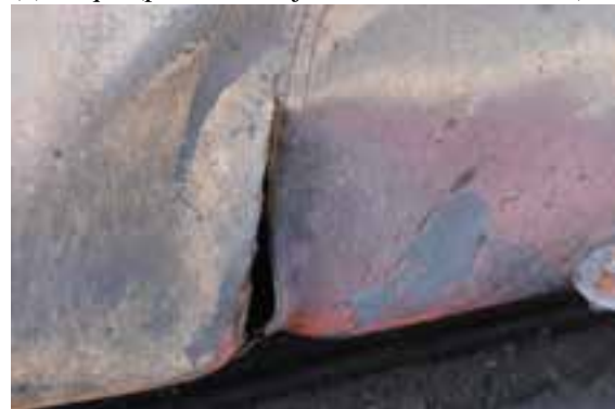
(f) Gros plan de la rupture indiquée par une flèche en (e)
