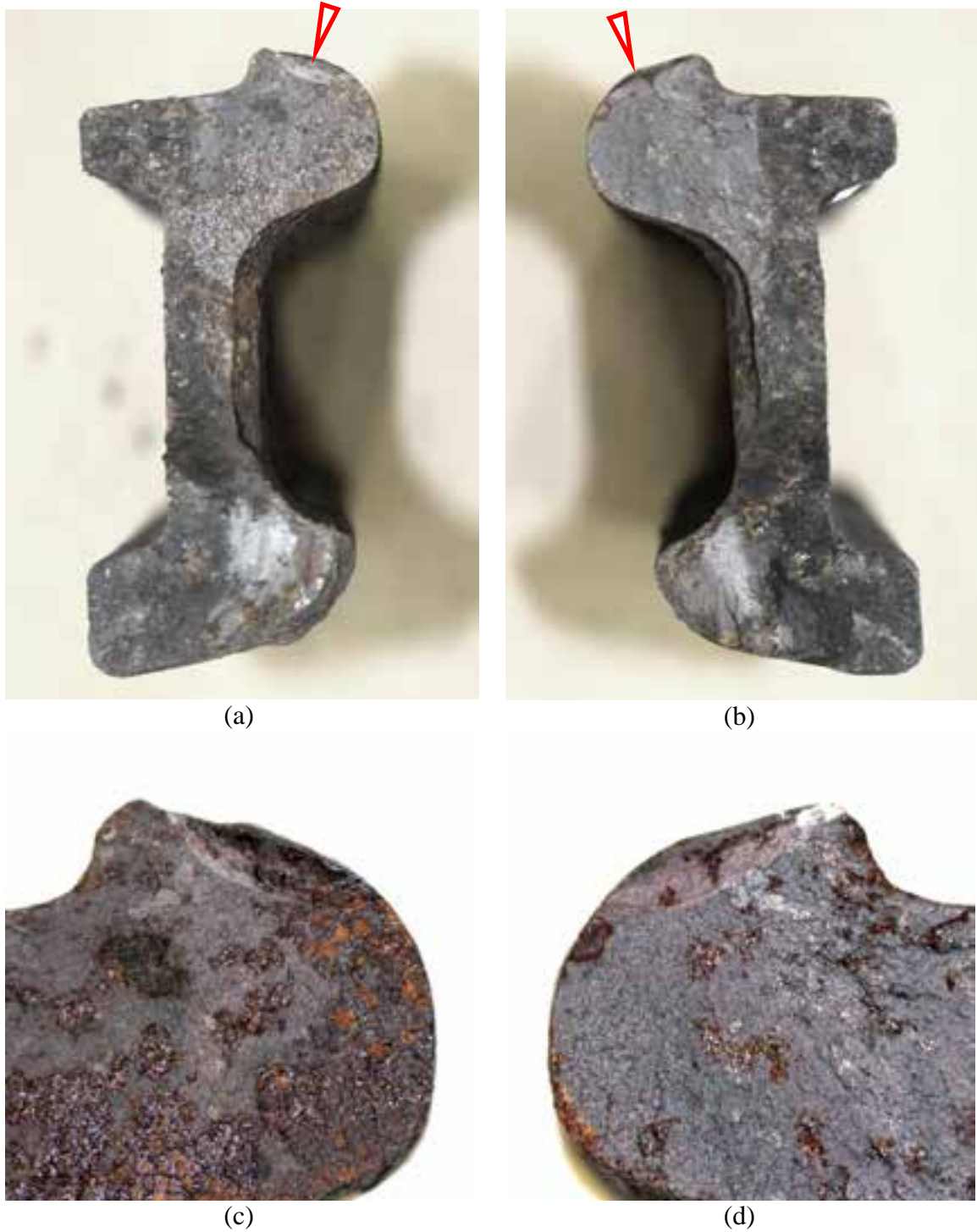
Figure 17 : Gros plans de deux surfaces de contact de la rupture du côté intérieur de l'éclisse
