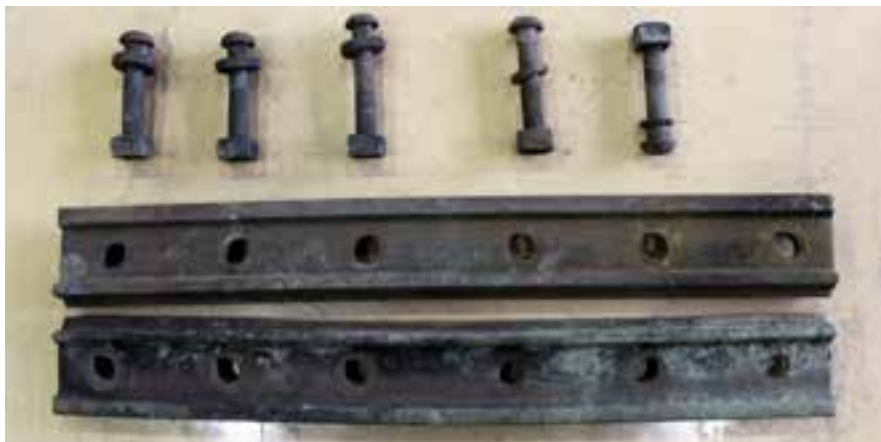
Figure 5 : Éclisses raccordant au cœur le rail de prolongement de pointe
