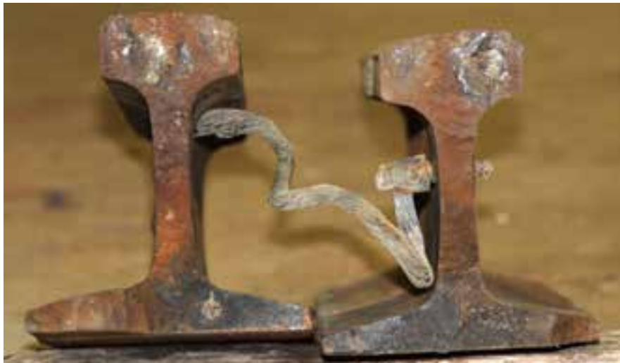
Figure 4 : Surfaces de rupture du rail gauche de prolongement de pointe
