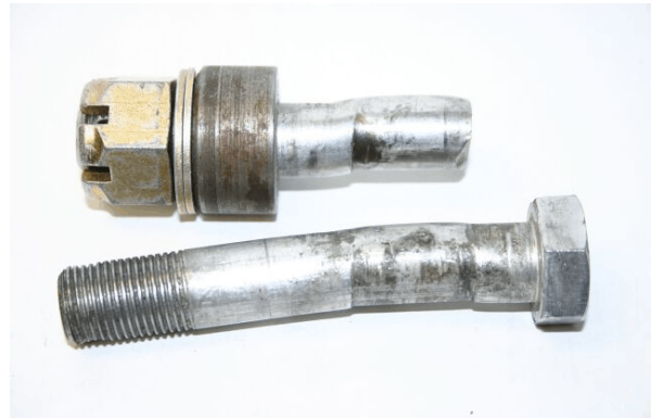
Photo 1. Boulon du haut cassé; aile droite. Boulon du bas déformé; aile gauche.
