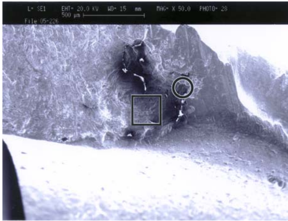
Photo 11. Représentation sous faible grossissement de la région endommagée située près du bord d'attaque. La partie encerclée montre l'emplacement de la porosité.
