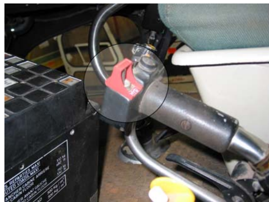
Photo 2. Commutateur de coupure du circuit hydraulique (bouton HYD CUT OFF)
