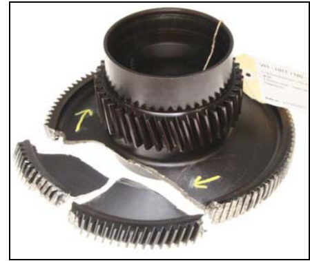
Photo 2. Roue dentée brisée de l'accident en Australie
