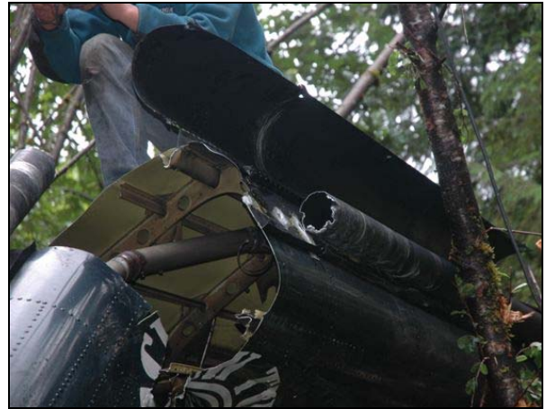
Photo 2. Arbre de transmission du rotor de queue fracturé
