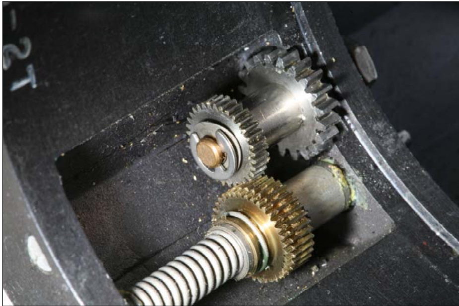
Engrenages de réglage de la pression barométrique/des aiguilles
