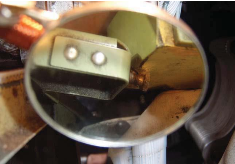
Figure 1 Contrepoids d'équilibrage coincé contre le boulon de butée
