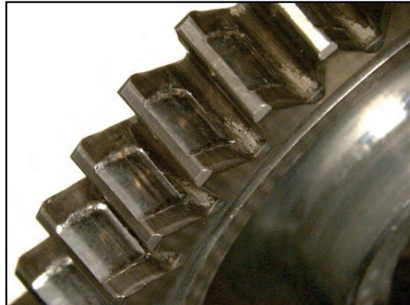
Photo 6. Usure sur la face et le flanc chargés des dents de l'engrenage 3103589-1
