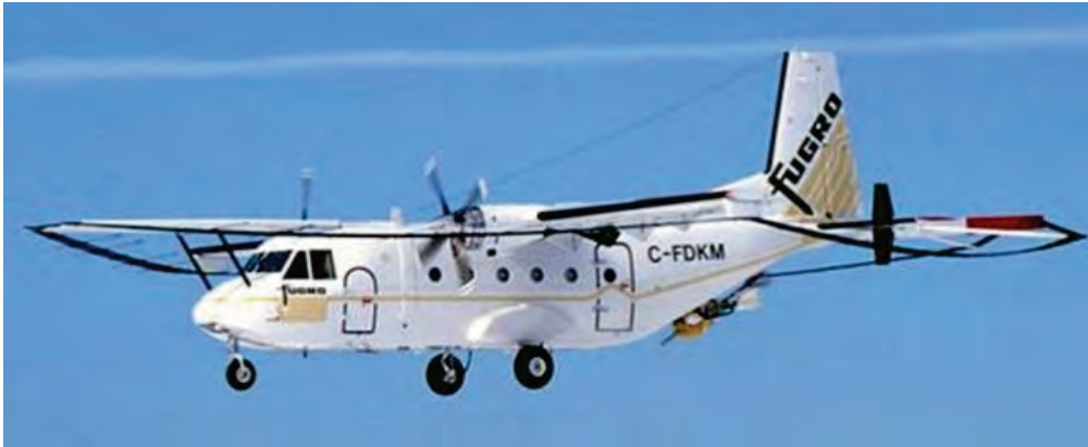
Photo 1. C-FDKM en vol avec magnétomètres arrimés (source : Fugro Aviation Canada Ltd., utilisée avec permission)
