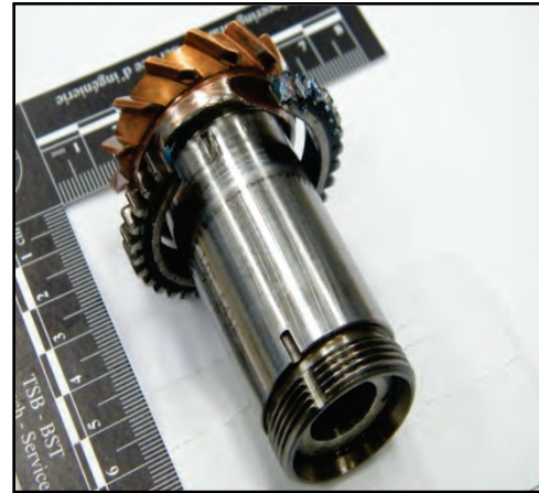
Photo 4. Roue droite cylindrique rompue sur l'arbre de détecteur de couple
