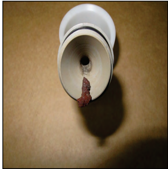
Photo 7. Buse de l'éjecteur 2 et corps étranger
