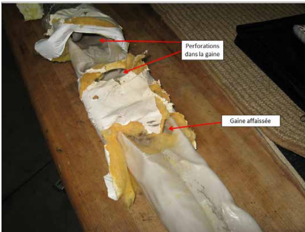
Photo 1. Gaines d'air chaud endommagées, dans l'état dans lequel elles ont été trouvées à bord de l'aéronef en cause dans l'événement.
