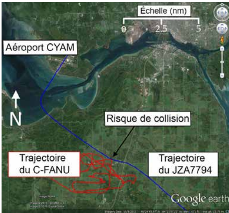
Figure 1. Représentation des trajectoires de vol qui ont mené au risque de collision (Source : Google Earth, avec annotations du BST)
