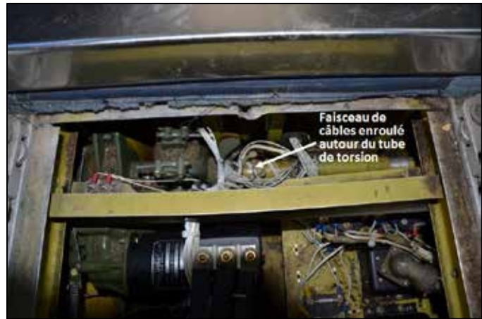
Photo 2. Faisceau de câbles enroulé autour du tube de torsion du train d'atterrissage
