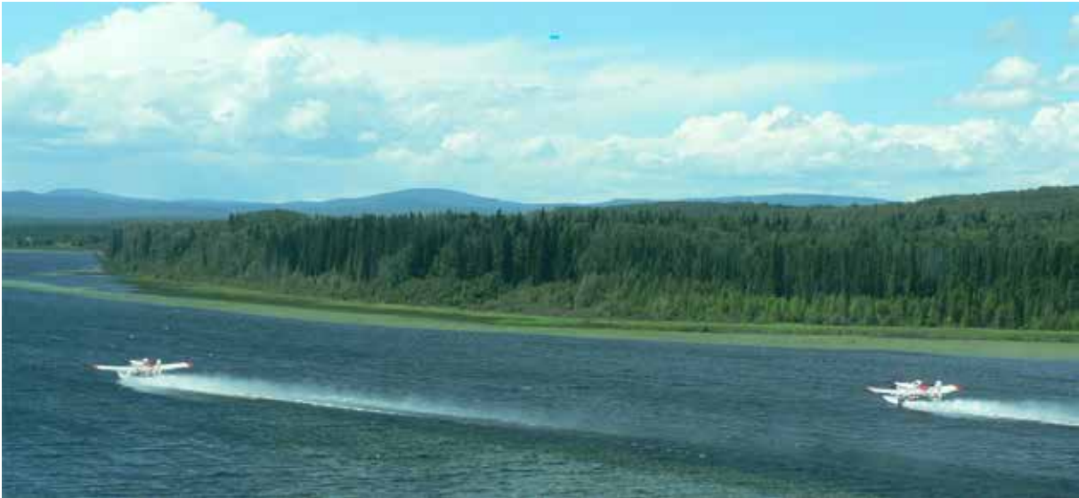
Photo 3. Manœuvre d'écopage en diagonale des Fire Boss
