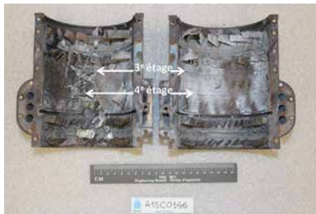
Figure 3. Demi-coquilles de carter du compresseur montrant les 3 e et 4 e étages du stator
