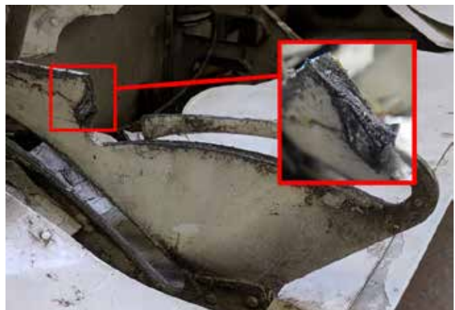
Figure 1. Rail de volet rompu, avec gros plan de la zone de rupture
