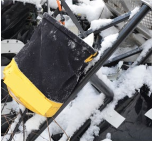
Figure 4. Sac à outils fixé à la rampe du Air Stair (Source : BST)
