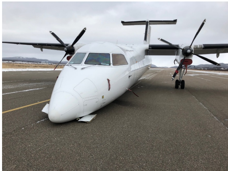
Figure 1. Aéronef à l'étude, au repos, le nez au sol (Source : PAL Airlines Ltd.)
