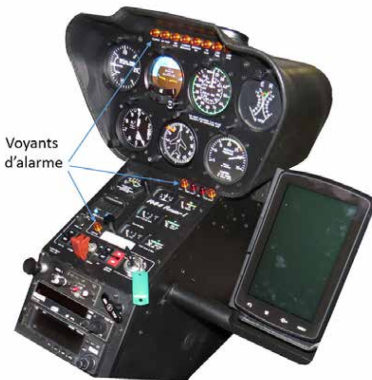
Figure 1. Tableau de bord typique d'un hélicoptère Robinson R44 Raven I
