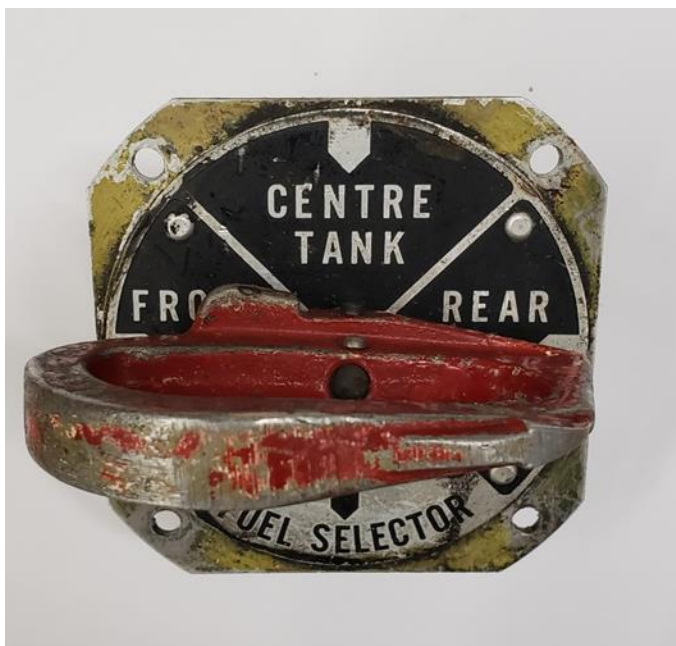
Figure 2. Sélecteur de carburant de l'aéronef en cause, avec le réservoir arrière sélectionné (Source : BST)
