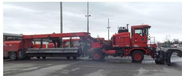
Figure 1. Balayeur chasse-neige CHA142, un camion HT muni d'un balai à neige XT remorqué (Source : BST)
