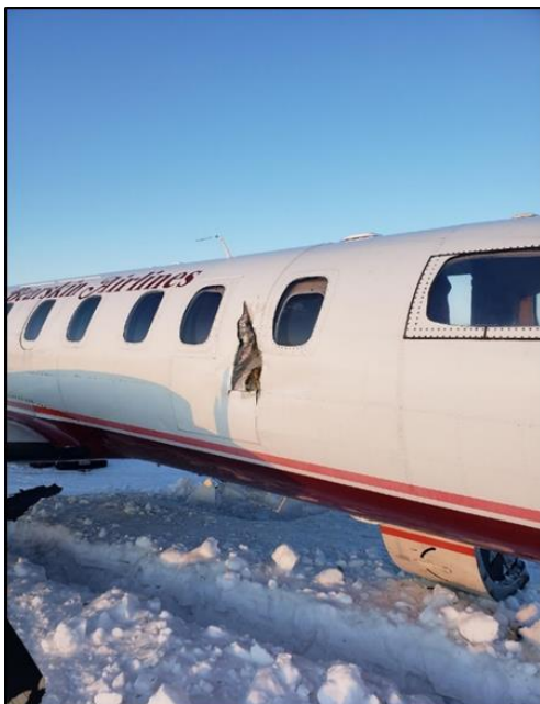
Figure 3. Pénétration du côté droit du fuselage (Source : Police provinciale de l'Ontario)
