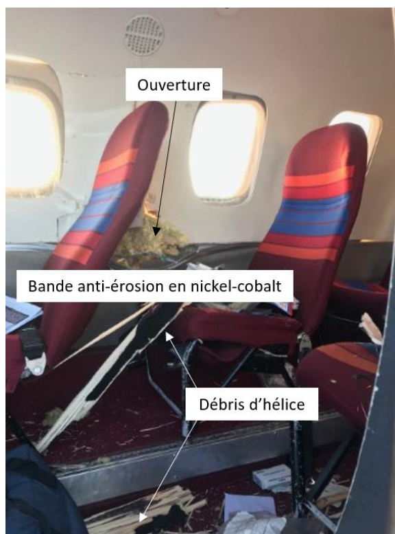
Figure 5. Débris d'hélice dans la cabine (Source : Police provinciale de l'Ontario, avec annotations du BST)
