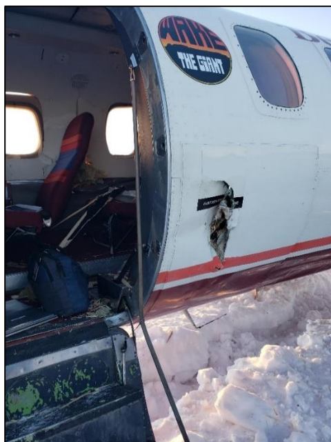
Figure 4. Pénétration du côté gauche du fuselage (Source : Police provinciale de l'Ontario)
