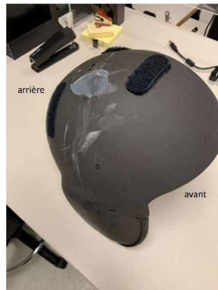
Figure 7. Traces de choc sur le dessus du casque du pilote (Source : SAG, et annotations du BST)
