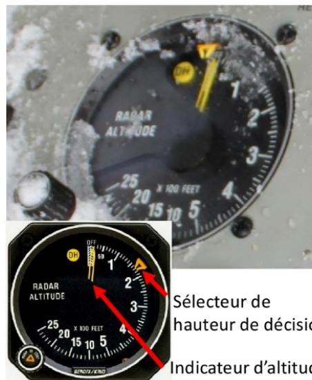
Figure 2. Radioaltimètre de l'aéronef de l'événement (Sources : BST [image principale] et brochure du fabricant [image en vignette])
