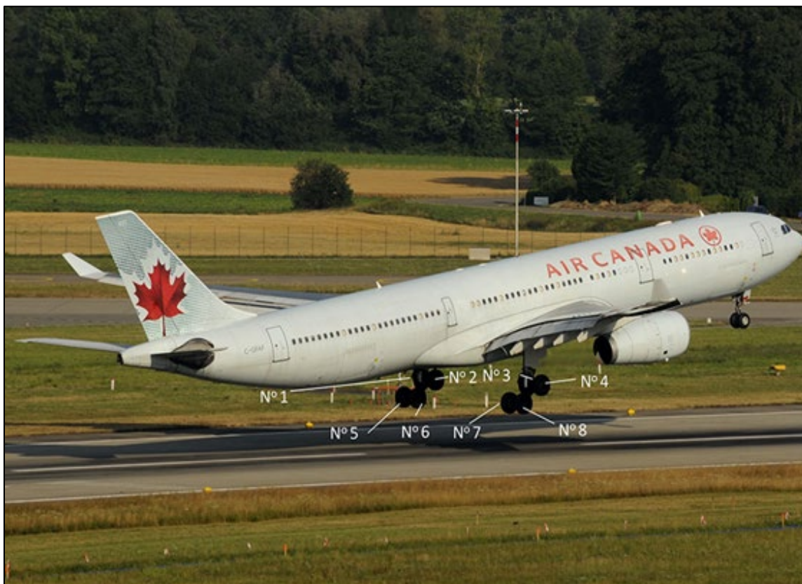
Figure 2. Trains d'atterrissage principaux de l'A330 et numérotation des roues (Source : Urs Ryser, avec annotations du BST)
