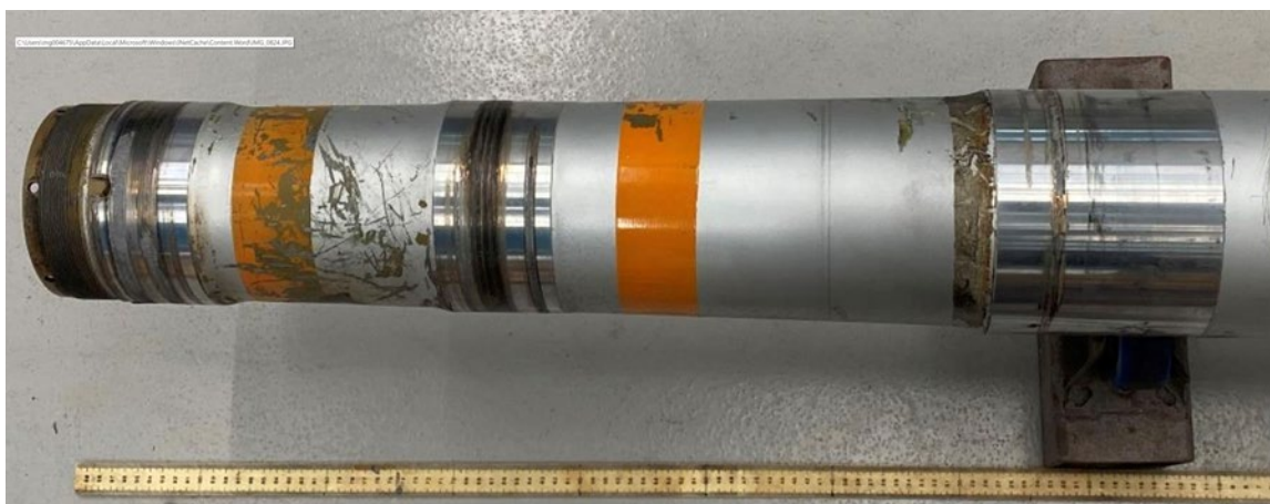
Figure 11. Essieu de la roue n° 4 endommagé au cours de l'incident du 17 décembre (Source : Safran)
