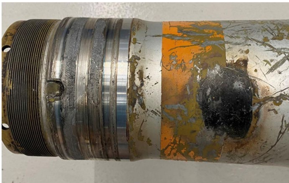
Figure 12. Traces de frottement sur l'essieu de la roue n° 4 endommagé au cours de l'incident du 17 décembre (Source : Safran)
