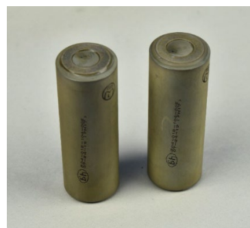
Figure 11. Exemple de goupille en acier inoxydable 316 à gauche et de goupille en acier à outils H11 à droite (Source : Bell Textron Inc.)
