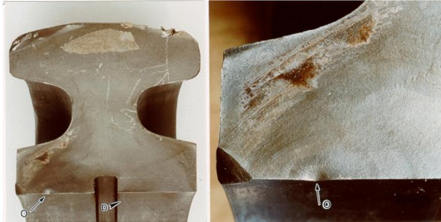
Le Bureau a déterminé que le chapeau de bielle s'est détaché de la bielle en raison d'une fracture et non d'une rupture des goujons. On note que la fissure s'est développée dans la section
