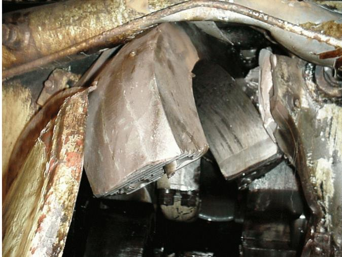
Des débris de la chemise, du piston, du coussinet, de la bielle, du contrepoids, du chapeau de bielle, du goujon, du coussinet et d'autres pièces étaient éparpillés dans le fond du carter près de la zone affectée par la rupture.
