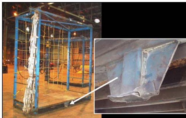
Photo 3. Pieds de la cage métallique déformés par l'explosion
