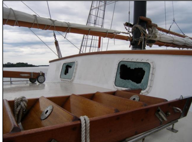
Photo 2. Fenêtres avant du rouf cassées par les pompiers pour ventiler les emménagements
