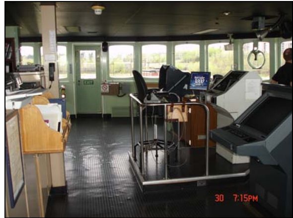
Photo 2. Poste de barre n° 1 et affichage ECS à gauche
