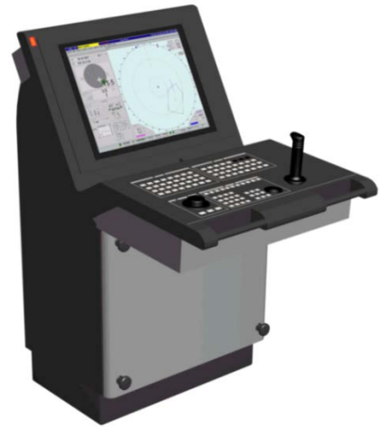
Figure 2. Pupitre d'exploitation du système de positionnement dynamique 9
