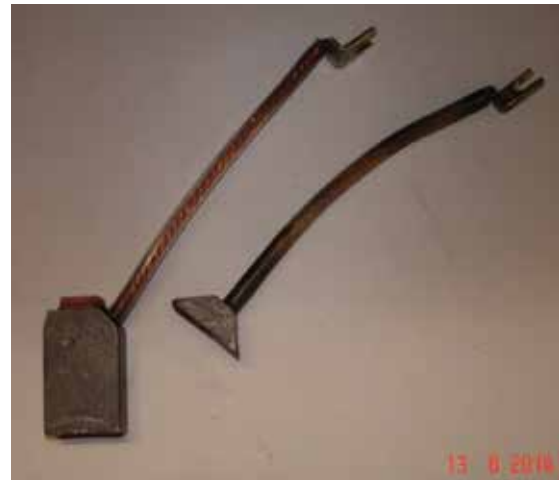
Photo 4. Comparaison entre un balai neuf (à gauche) et le balai usé du groupe électrogène n° 1 (à droite)
