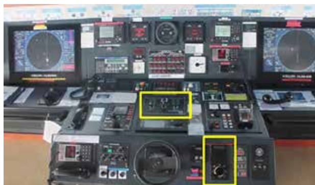
Photo 8. Pupitre principal de la passerelle à bord du Mehmet A (les panneaux de commande de l'appareil à gouverner sont encadrés en jaune)
