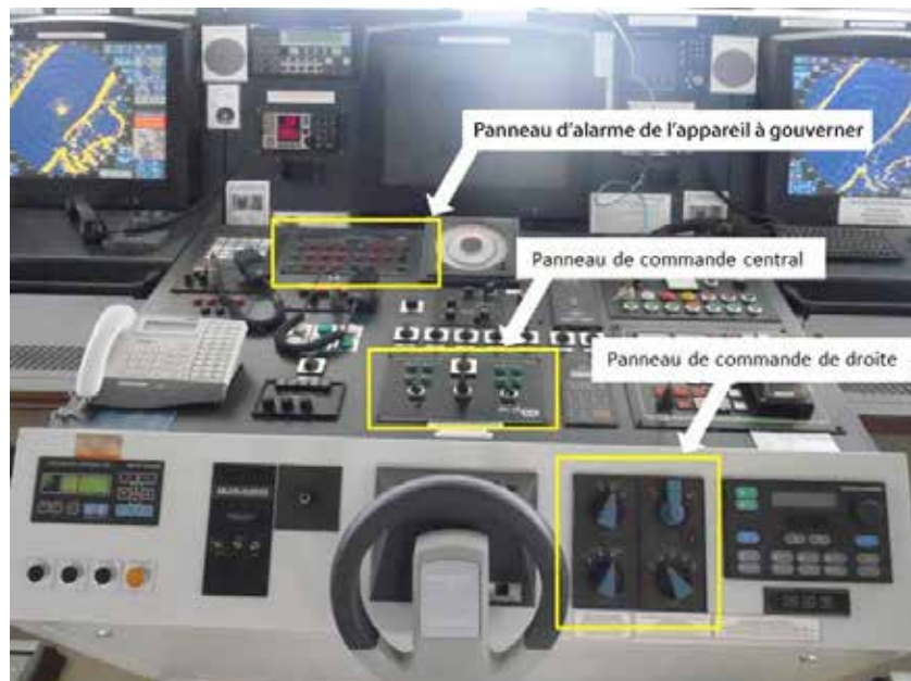
Photo 2. Pupitre principal de la passerelle sur le Halit Bey
