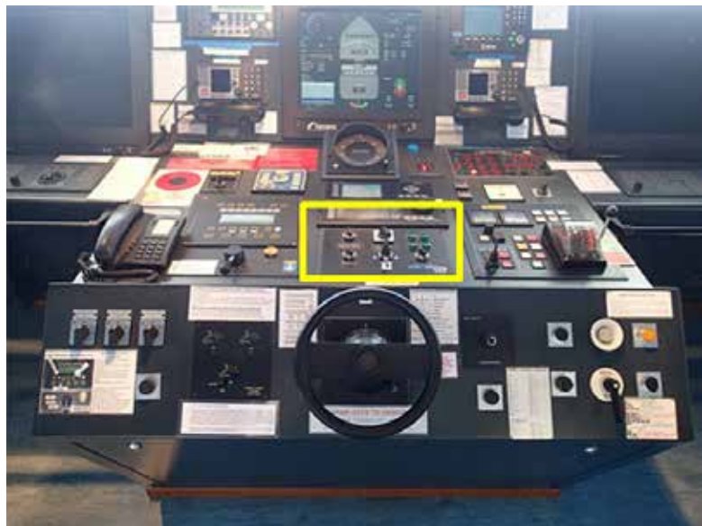
Photo 6. Pupitre de commande central de la passerelle du Manas (le panneau de commande de l'appareil à gouverner est encadré en jaune)
