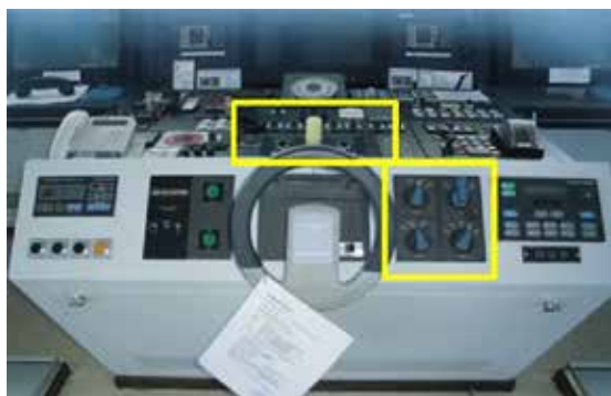
Photo 7. Pupitre principal de la passerelle à bord du Nilufer Sultan (les panneaux de commande de l'appareil à gouverner sont encadrés en jaune)
