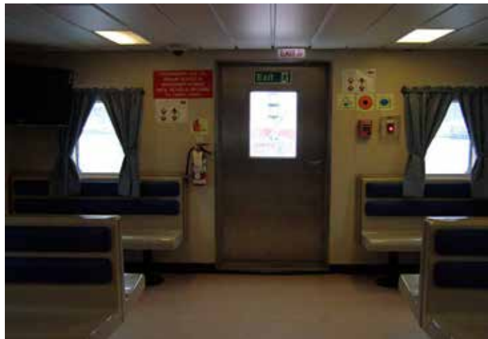
Photo 5. Sortie arrière du salon des passagers (gilets de sauvetage sur le pont derrière la porte, mais aucune signalisation)
