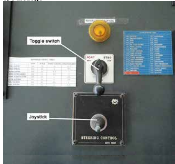
Photo 5. Commande de barre non suivie à sélecteur et à manette
