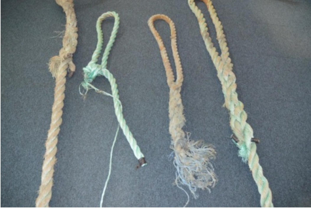
Câble de 48 mm en copolymère trouvé sur le HM Tacoma
