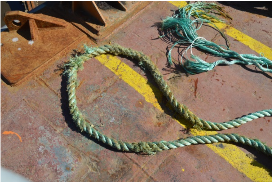
Câble de 48 mm en copolymère trouvé sur le HM Tacoma
