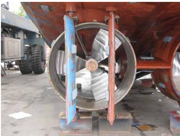
Figure 8. Alignement du gouvernail de bâbord du C.T. Titan
