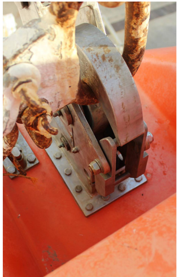
Figure 4. Croc de dégagement avec maillon de fermeture de l'embarcation de sauvetage de tribord du Northern Ranger (Source : BST)
