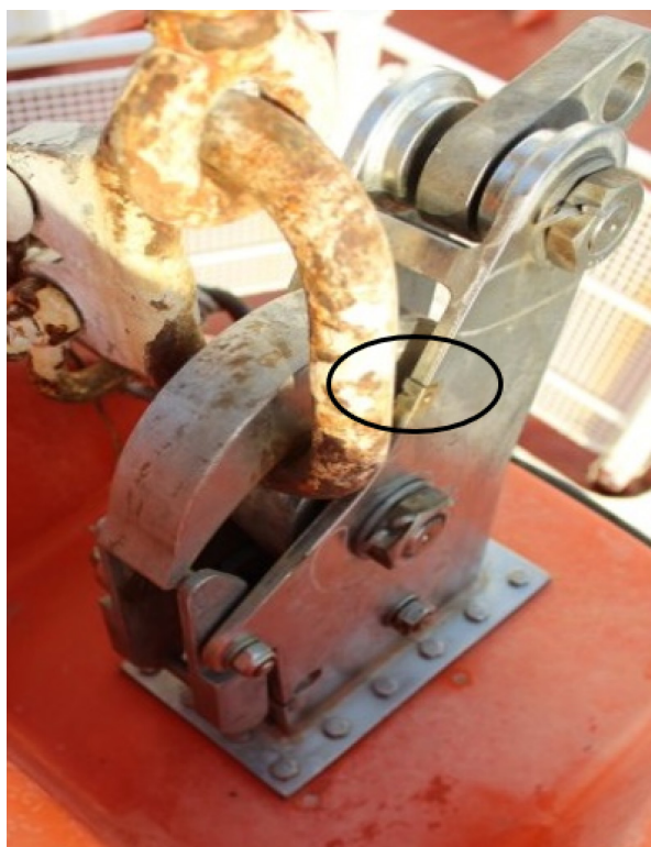
Figure 9. Croc de dégagement avant de l'embarcation de sauvetage en position fermée, avec indicateurs de position de verrouillage du croc alignés (cercle noir). La vue de l'opérateur serait obstruée par le maillon de fermeture. (Source : BST)
