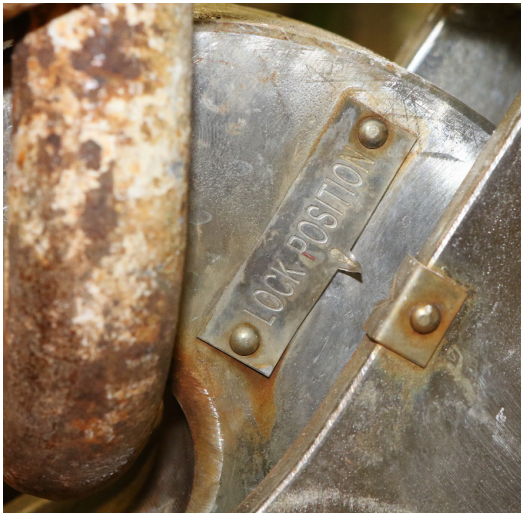
Figure 11. Gros plan de l'indicateur de position de verrouillage du croc de dégagement avant (aligné en position de réenclenchement et verrouillé) (Source : BST)
