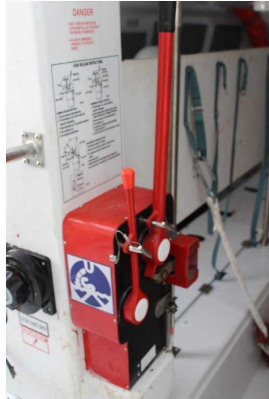
Figure 5. Mécanisme de largage sous tension/hors tension et instructions d'utilisation à bord de l'embarcation de sauvetage de tribord du Northern Ranger (Source : BST)
