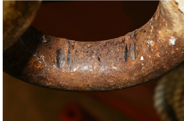
Figure 15. Déformation du maillon de fermeture avant à bord du Northern Ranger (Source : BST)
