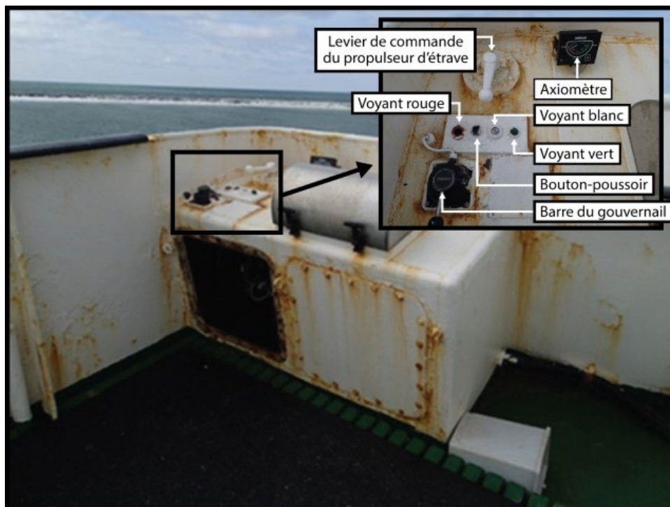
Figure 12. Console d'aileron de passerelle bâbord (Source : BST)
