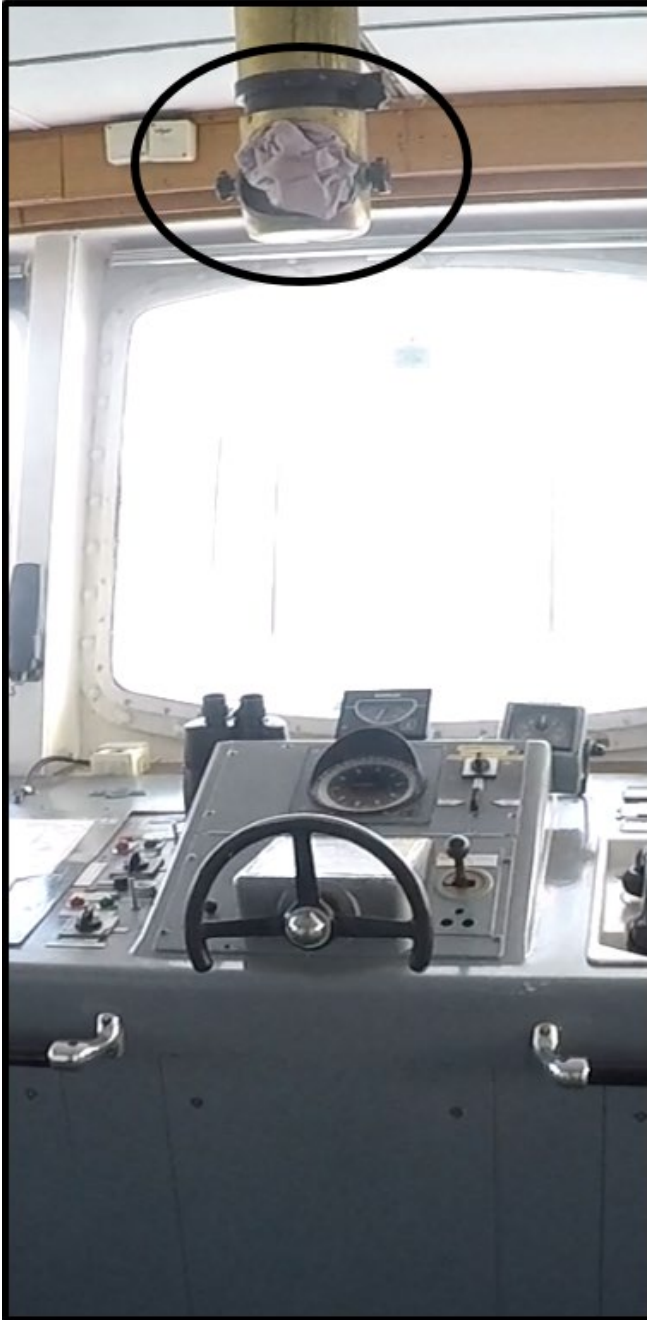
Figure G32. Chiffon enfoncé dans le tube de réflecteur de compas magnétique (Source : BST)
