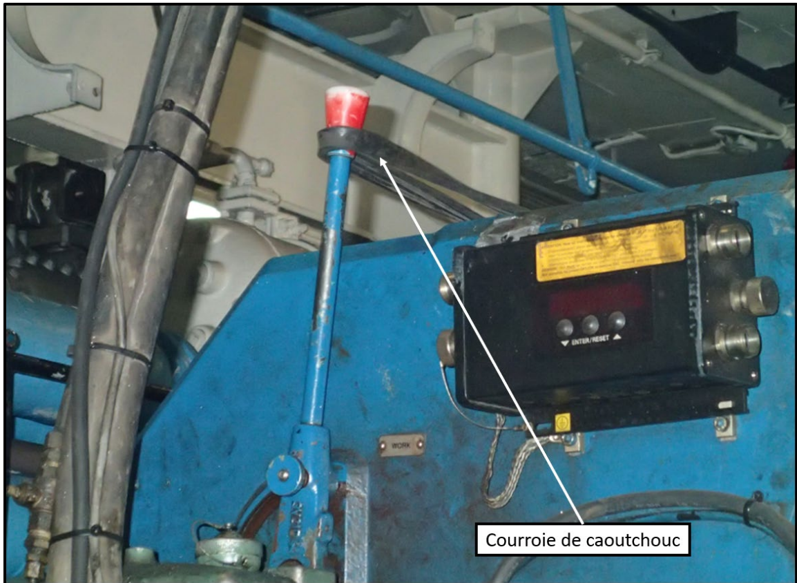
Figure G22. Courroie de caoutchouc maintenant le levier en place (Source : BST)
