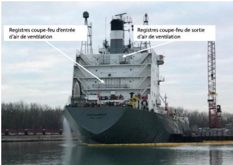
Figure 5. Vue arrière de la superstructure du navire, qui montre l'emplacement des registres coupe-feu de la ventilation de la salle des machines (Source : T&T Marine Salvage Inc., avec annotations du BST)
