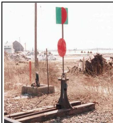
L'appareil de manœuvre d'aiguillage était équipé d'un cadenas d'aiguillage standard du CN (voir la figure 9). Le mécanisme de fermeture de l'arceau était brisé et le cadenas pendait au bout de la chaîne servant à fixer le cadenas à l'appareil de manœuvre. On a relevé de nombreuses bosselures et déformations sur le cadenas
