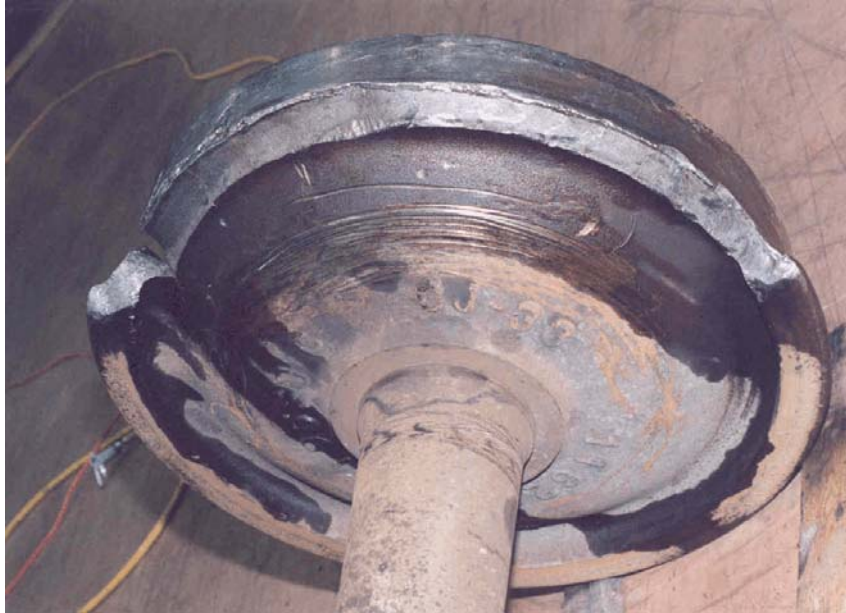
Photo 1. Fracture de la jante de la roue L-3 du wagon DTTX 25029
