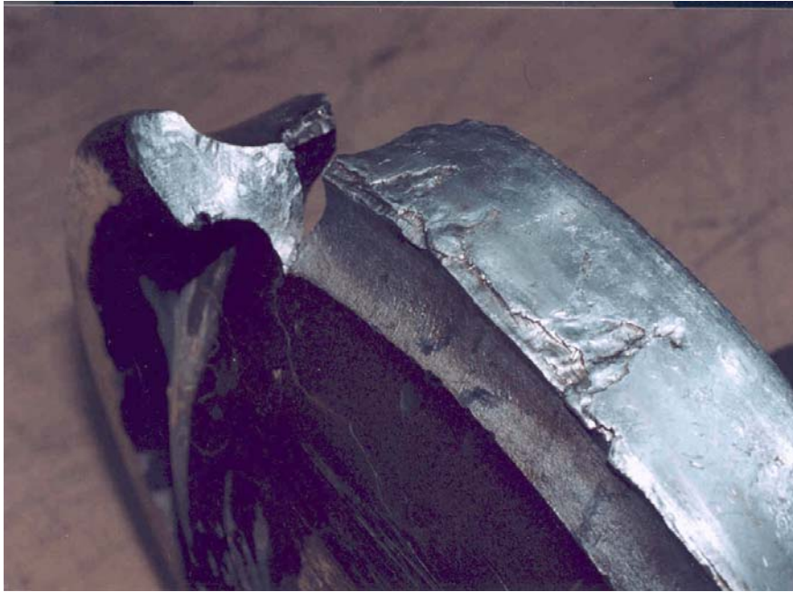
Photo 2. Écaillage de la table de roulement
